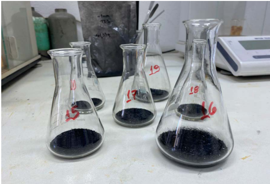
Εικόνα 2-2: Κωνικές φιάλες που περιέχουν τη ζυγισμένη μάζα δείγματος προς εκχύλιση
