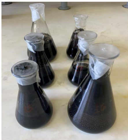
Εικόνα 2-5: Τα διαλύματα των δοκιμών εκχύλισης έπειτα από 24 h ανάδευσης
