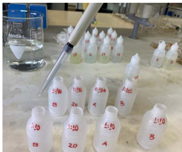
Εικόνα 2-8: Προσθήκη διηθημένου διαλύματος σε φιαλίδια για πραγματοποίηση αραίωσης
