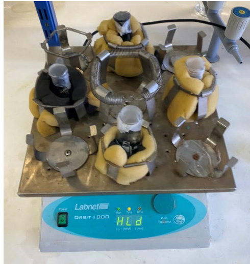
Εικόνα 2-4: Τράπεζα ανάδευσης με κωνικές φιάλες δοκιμών εκχύλισης
