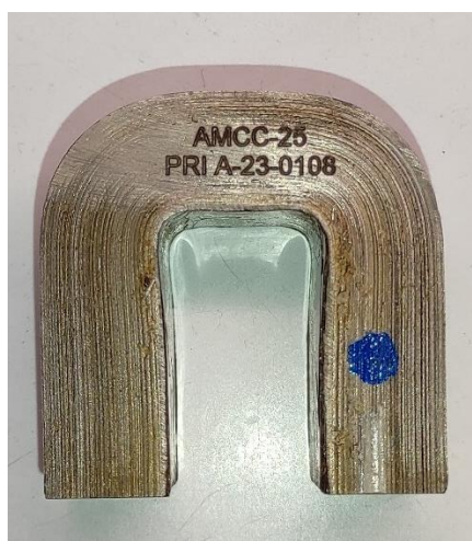
Εικόνα 33: Πυρήνας πηνίου διέγερσης από άμορφο κράμα σιδήρου.
