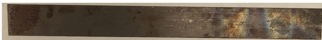
Εικόνα 31: Δείγμα 2: Δείγμα με μέτρια καταπόνηση.
