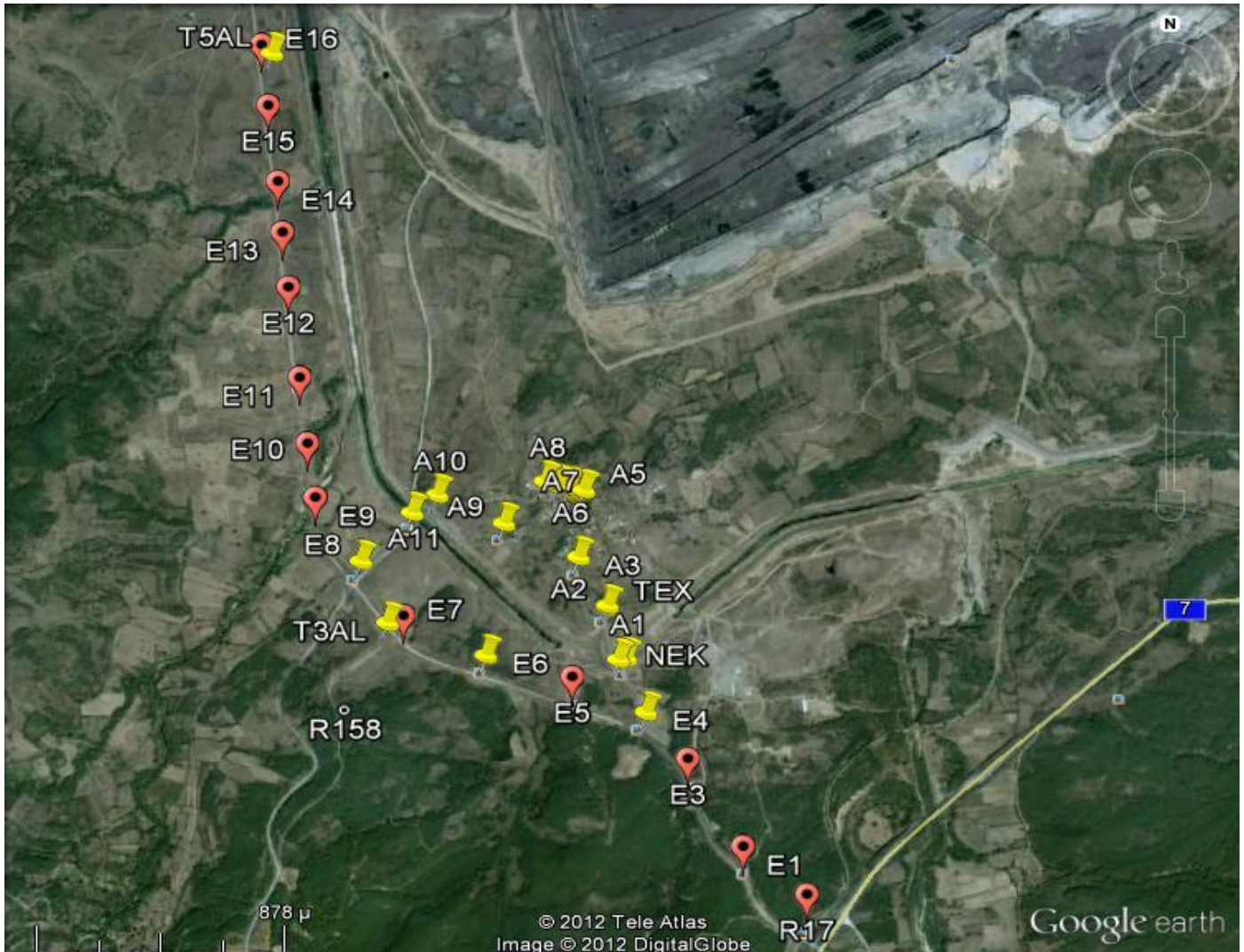
Εικόνα 4.2 Σύνολο σημείων G.P.S και χωροσταθμικού δικτύου
