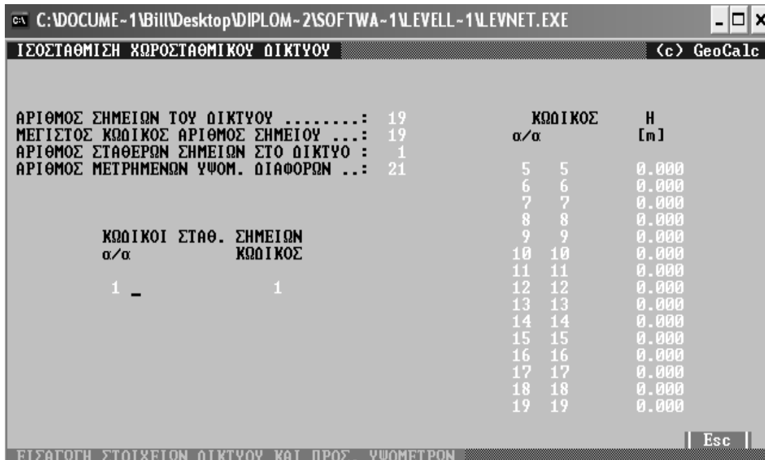
Εικόνα 5.6 Εισαγωγή στοιχείων δικτύου και προσωρινών υψομέτρων
