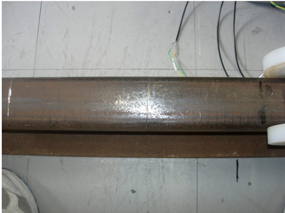
Εικόνα 8.2 Τεχνητή ατέλεια στην κεφαλή σιδηροτροχιάς UIC 54.
