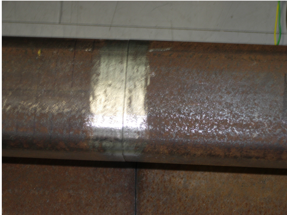
Εικόνα 8.3 Δημιουργία τεχνητής ασυνέχειας με τη συνένωση δύο σιδηροτροχιών
