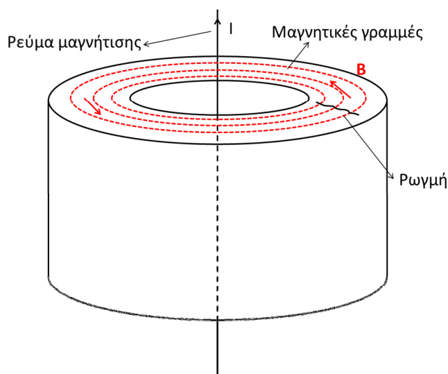
Εικόνα 3.1.7 Έλεγχος δακτυλιοειδούς εξαρτήματος για τη εύρεση ακτινικών ρωγμών.
