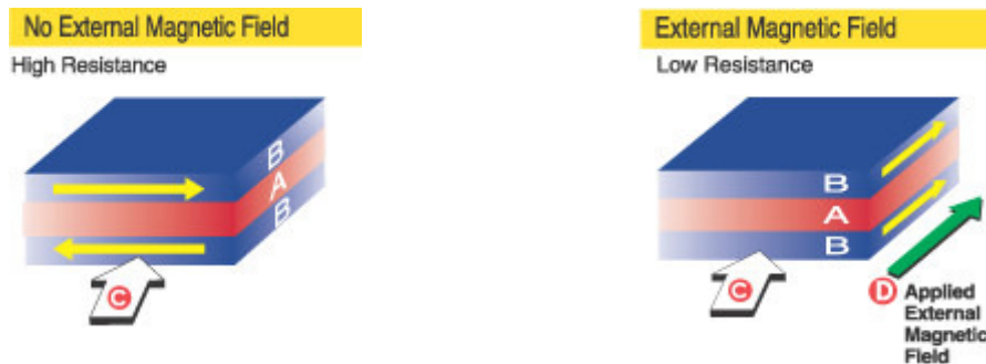
Εικόνα 3.2.3.3 Η κατάσταση του αισθητήρα όταν αυτός δε βρίσκεται μέσα σε μαγνητικό πεδίο και όταν βρίσκεται. Το στρώμα A αποτελείται από μη μαγνητικό αγώγιμο υλικό, ενώ τα στρώματα τύπου B αποτελούνται από σιδηρομαγνητικό υλικό. (Πηγή: Διαδίκτυο)
