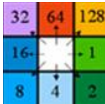
Εικόνα 3.1: Τιμή κεντρικού εικονοστοιχείου ανάλογα με τον κάνναβο διεύθυνσης απορροής(Στάμου-Σκοπελίτη, 2009)
