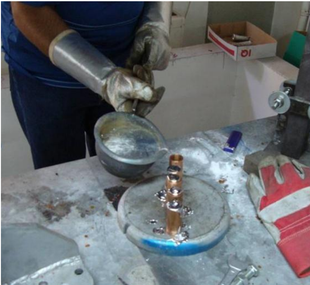
Εικόνα 2.2: Χύτευση αλουμινίου στο εσωτερικό του χαλκού.
