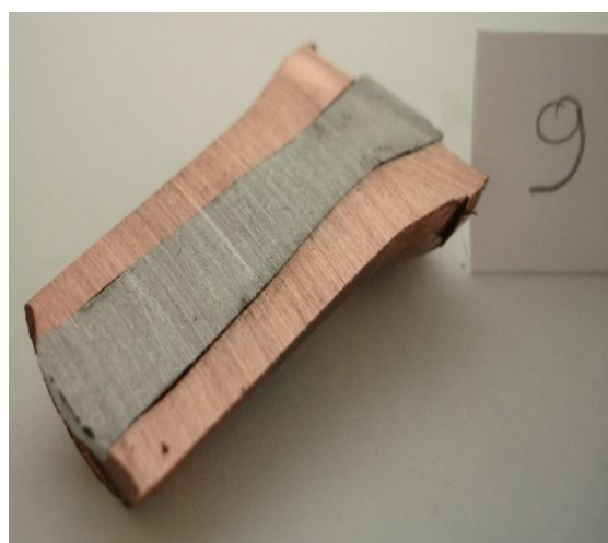
Εικόνα 3.6: Δοκίμιο με διάμετρο αλουμινίου 15 mm.
