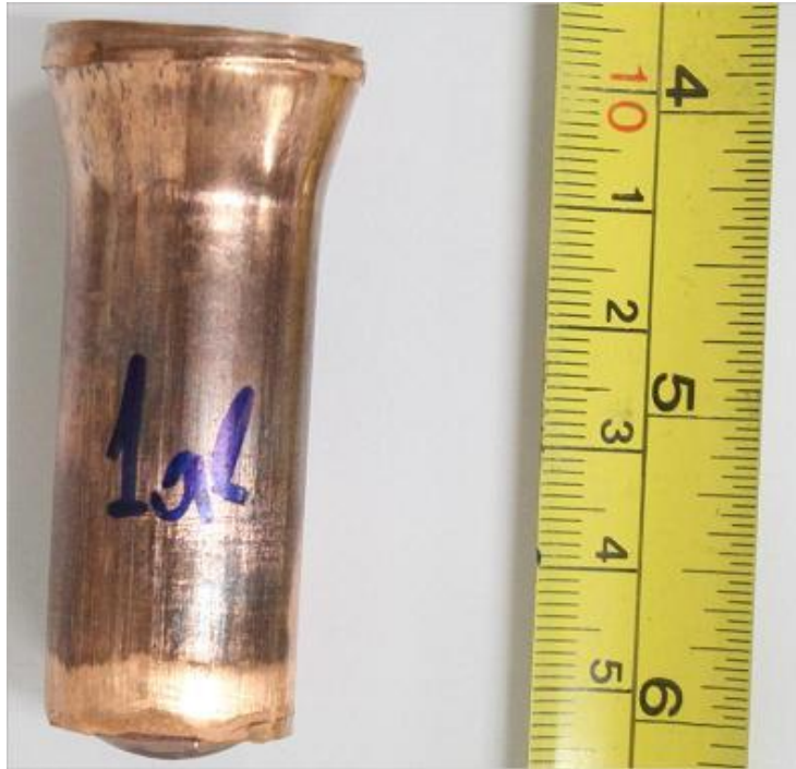
Εικόνα 5.2: Δοκίμιο N° 1 μετά τη διέλαση.
