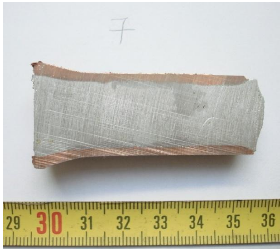
Εικόνα 3.4: Δοκίμιο με διάμετρο αλουμινίου 20 mm.
