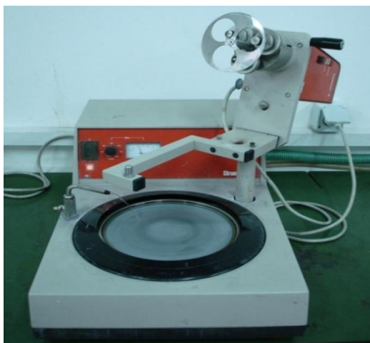
Εικόνα 3.11: Το λειαντικό μηχάνημα που χρησιμοποιήθηκε.
