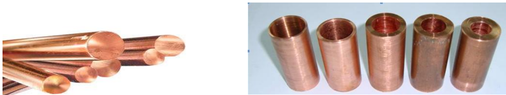
Εικόνα 2.1: Συμπαγείς ράβδοι ηλεκτρολυτικού χαλκού (αριστερά) και εξωτερικοί δακτύλιοι (δεξιά).
