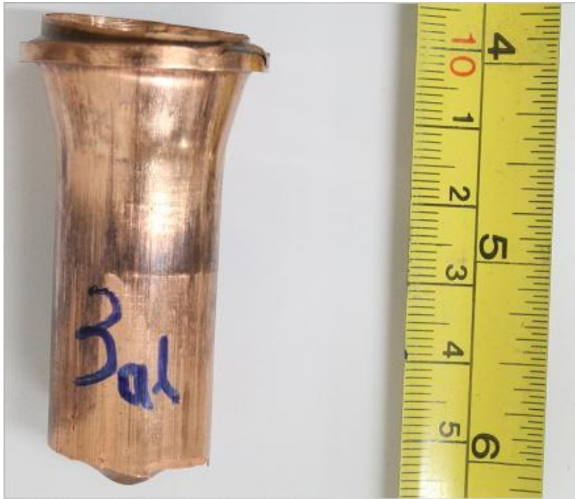
Εικόνα 5.6: Δοκίμιο N° 3 μετά την διάλυση.
