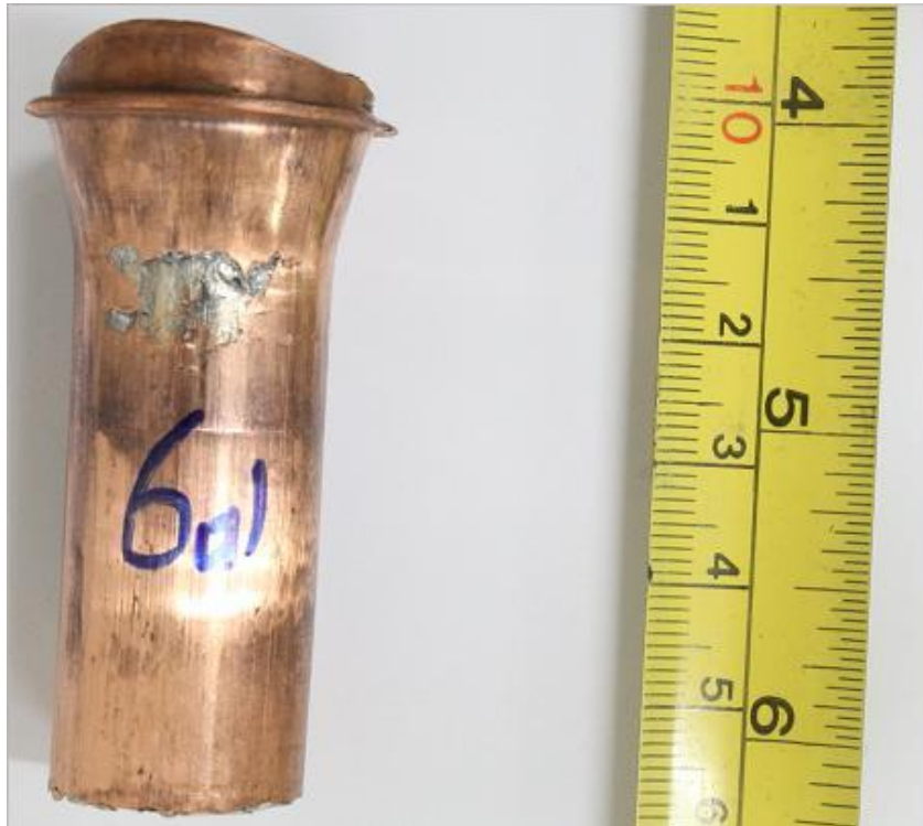
Εικόνα 5.12: Δοκίμιο N° 6 μετά την διάλυση.
