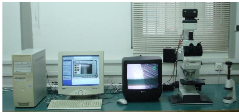
Εικόνα 3.8: Στερεοσκόπιο (πάνω), μικροσκόπιο συνδεδεμένο με Η/Υ και οθόνη τηλεόρασης (κάτω), που χρησιμοποιήθηκαν για την παρατήρηση των δοκιμίων.
