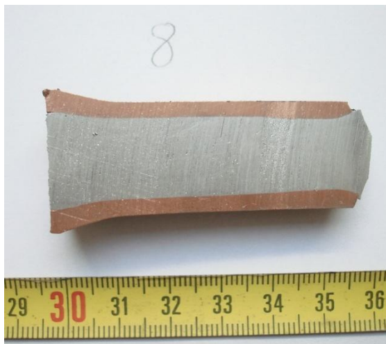
Εικόνα 3.5: Δοκίμιο με διάμετρο αλουμινίου 17.7 mm.
