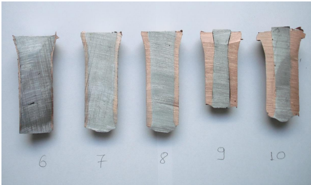
Εικόνα 3.2 : Το ένα από τα δύο μέρη του δοκιμίου μετά την κοπή με διάμετρο αλουμινίου 22 (N ο 6) , 20 (N ο 7), 17,7 (N ο 8), 15 (N ο 9) και 12,5 (N ο 10) mm.
