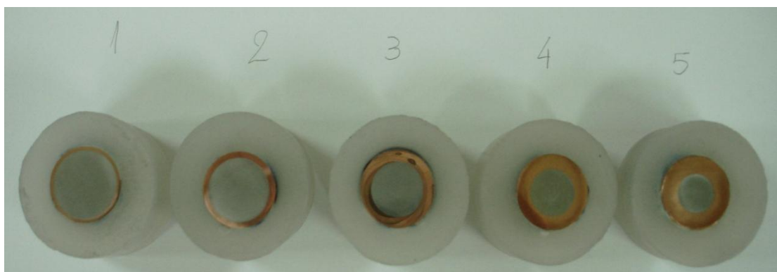
Εικόνα 3.17: Δοκίμια με πυθμένα μετά τον εγκιβωτισμό.
