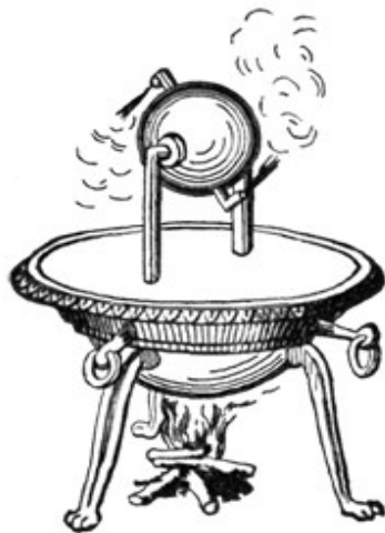
Εικόνα 2: Η αιολόσφαιρα του Ήρωνα [1]
