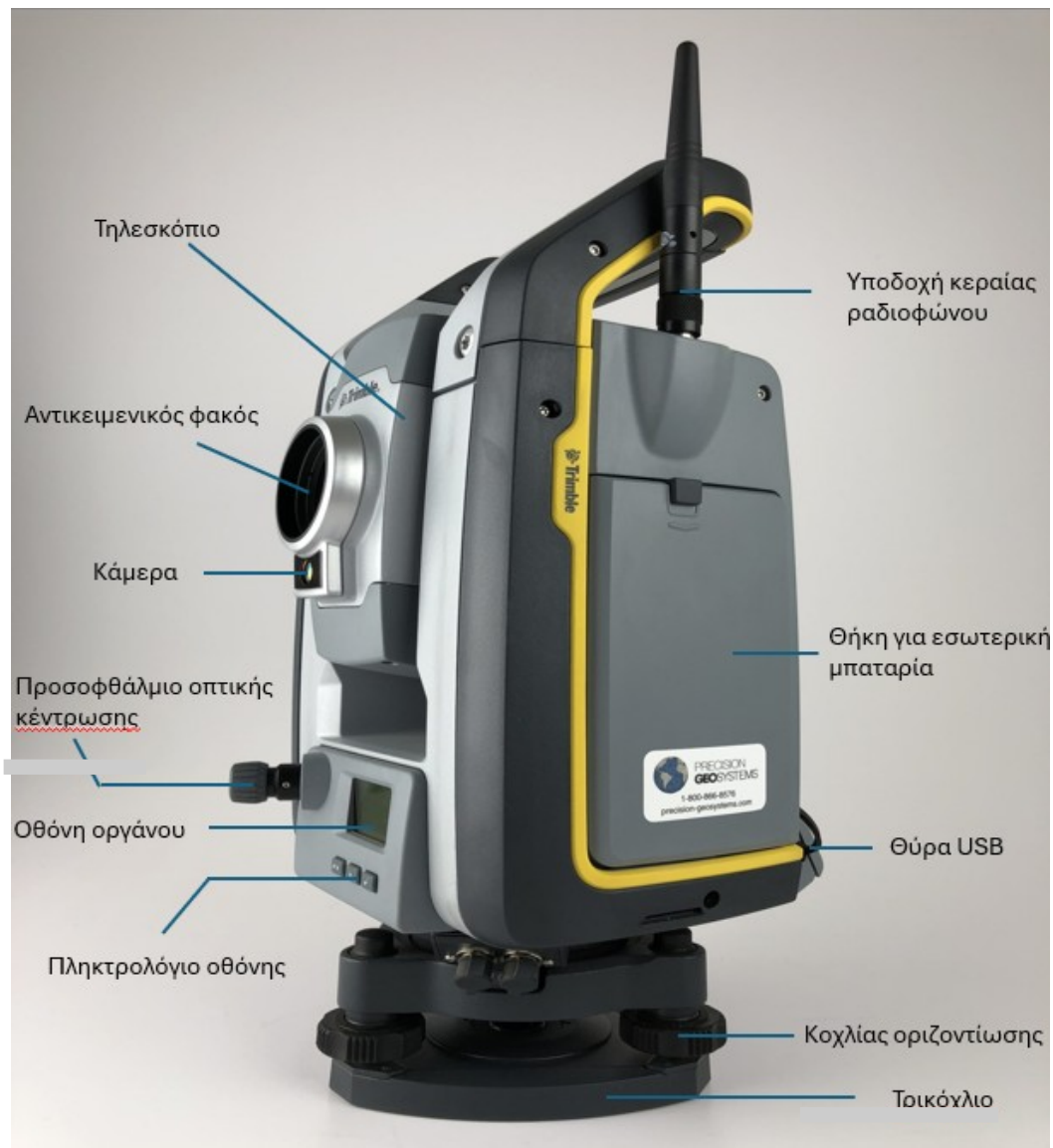
Σχήμα 8: Β' τοπική όψη ρομποτικού γεωδαιτικού σταθμού
