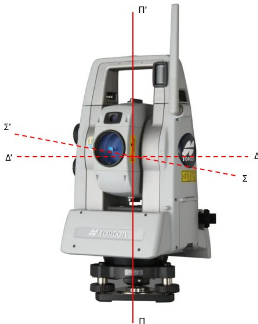
Σχήμα 6: Οι τρεις άξονες του ρομποτικού γεωδαιτικού σταθμού
