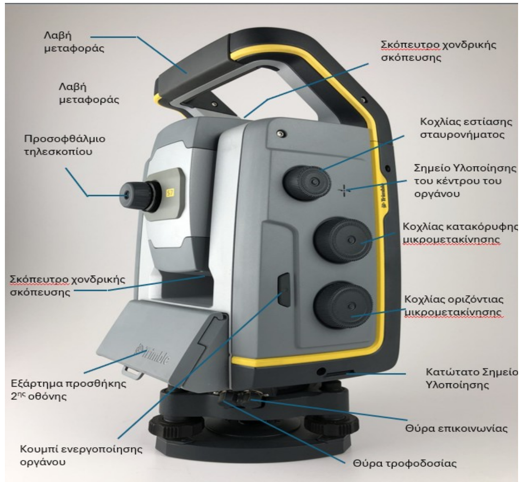
Σχήμα 7: Α' τυπική όψη ρομποτικού γεωδαιτικού σταθμού
