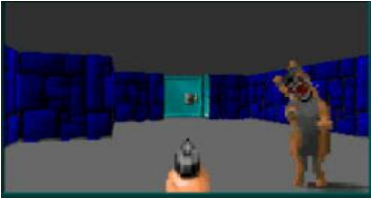
Εικόνα 2: Σκηνή από το παιχνίδι Wolfenstein 3D (iD Software) (Ray casting).Είναι εμφανές πως τα αντικείμενα (όπλο) και ο εχθρός (σκύλος) δεν είναι τρισδιάστατα είναι σαν είναι κολλημένα στην εικόνα σε κατάλληλη κλίμακα [39]
