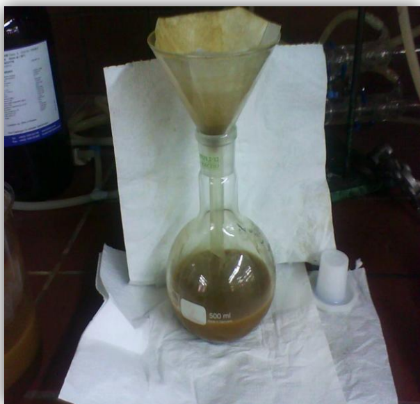
Σχήμα 5.6: (α) Διήθηση του εκχυλίσματος (β) Εξάτμιση του διηθήματος
