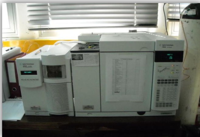
Σχήμα 5.2 : Η συσκευή GC-MS που χρησιμοποιήθηκε (GC: Agilent 7890A, MS: Agilent 5975C)
