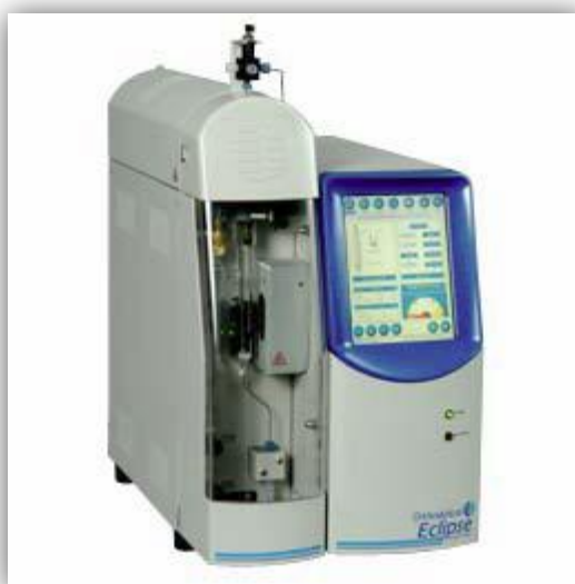
Σχήμα 5.1 : Η συσκευή P&T που χρησιμοποιήθηκε (Eclipse 4660, OI Analytical)
