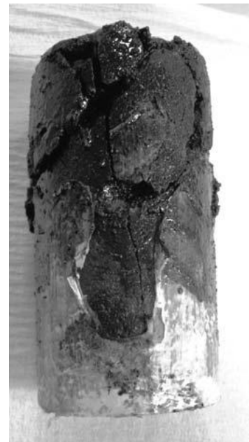
Σχήμα 7.4: Ερπυστική καμπύλη για t=18\text{MPa} (σημείο K) και φωτογραφία δείγματος μετά το τέλος του πειράματος A17a.
