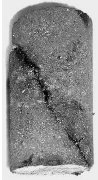
Εικόνα 7.3: Δείγμα άνθρακα μετά το τέλος του πειράματος A11a (αστοχία).
