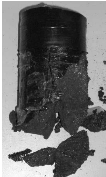
Εικόνα 7.4: Δείγμα μετά το τέλος του πειράματος A17d (αστοχία).
