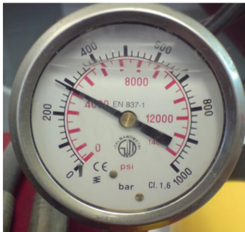
Σχήμα 2-13 Το πιεσόμετρο της αντλίας της ηλεκτρο-υδραυλικής πρέσας
