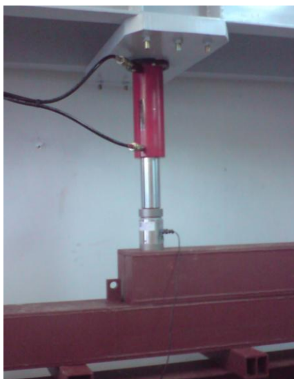
Σχήμα 2-9 Η θέση της δυναμοκυψέλης στο σύστημα φόρτισης
