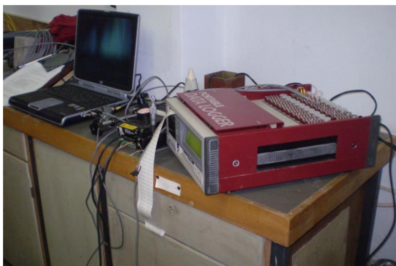
Σχήμα 2-11 Το ηλεκτρονικό σύστημα καταγραφής, data logger
