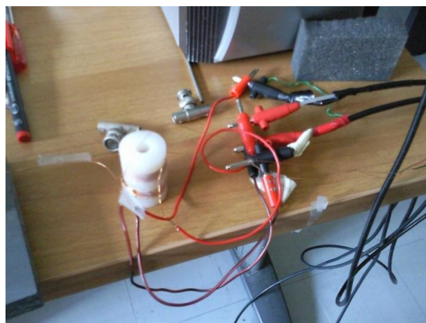
Σχήμα 5.8 Δοκιμαστική συνδεσμολογία του μετρητικού ζεύγους πηνίων (pick-up coils) με την λιγότερο πυκνή τύλιξη σύρματος.
