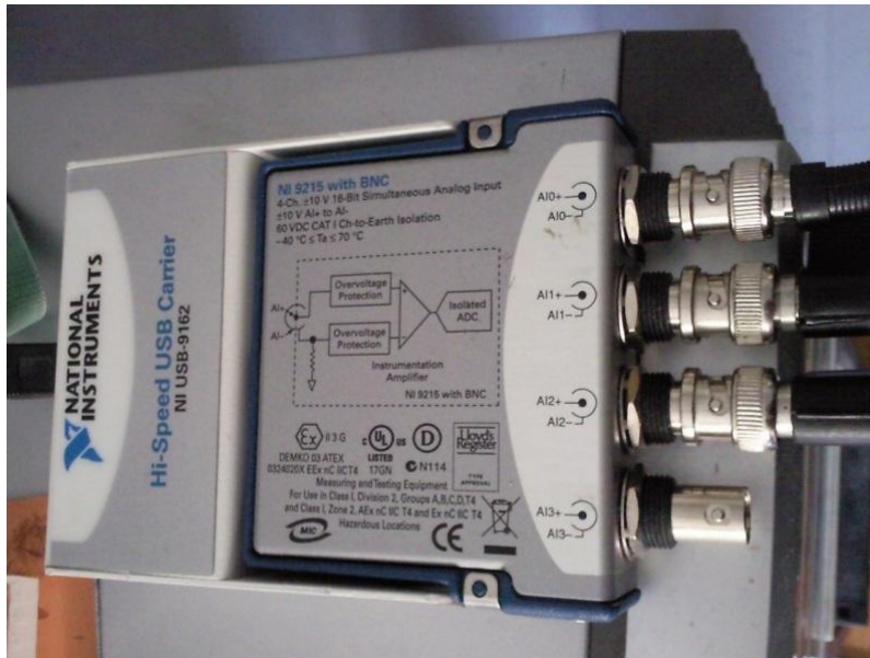
Σχήμα 5.14 Κάρτα συλλογής δεδομένων (data acquisition card) USB NI 9162 της National Instruments με ακροδέκτες BNC.
