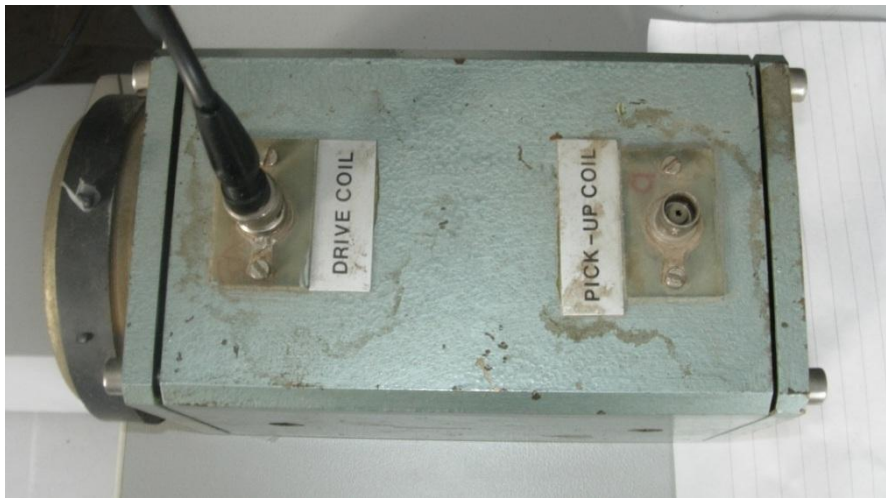
Σχήμα 5.2 Ηλεκτρομαγνητικός ταλαντωτής για την ταλάντωση του δείγματος.
