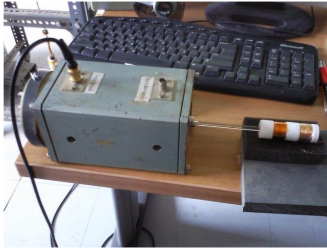
Σχήμα 5.7 Οι πρώτες δοκιμαστικές μετρήσεις με δείγμα ένα κομμάτι μόνιμου μαγνήτη στο ζεύγος πηνίων με την πυκνότερη τύλιξη σύρματος.
