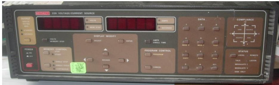
Σχήμα 5.11 Η πηγή σταθερού ρεύματος με την οποία τροφοδοτήσαμε το πηνίο που δημιουργεί το DC μαγνητικό πεδίο για τη μαγνήτιση του δείγματος.
