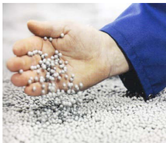
Σχήμα 15: Διογκωμένη πολυστερίνη με γραφίτη σε χύμα μορφή (με τον ενσωματωμένο γραφίτη το υλικό επιτυγχάνει ουσιαστικά την ανάκλαση της ηλιακής ακτινοβολίας και περιορίζει έτσι την αναπτυσσόμενη θερμότητα από την απορροφούμενη ποσότητα.
