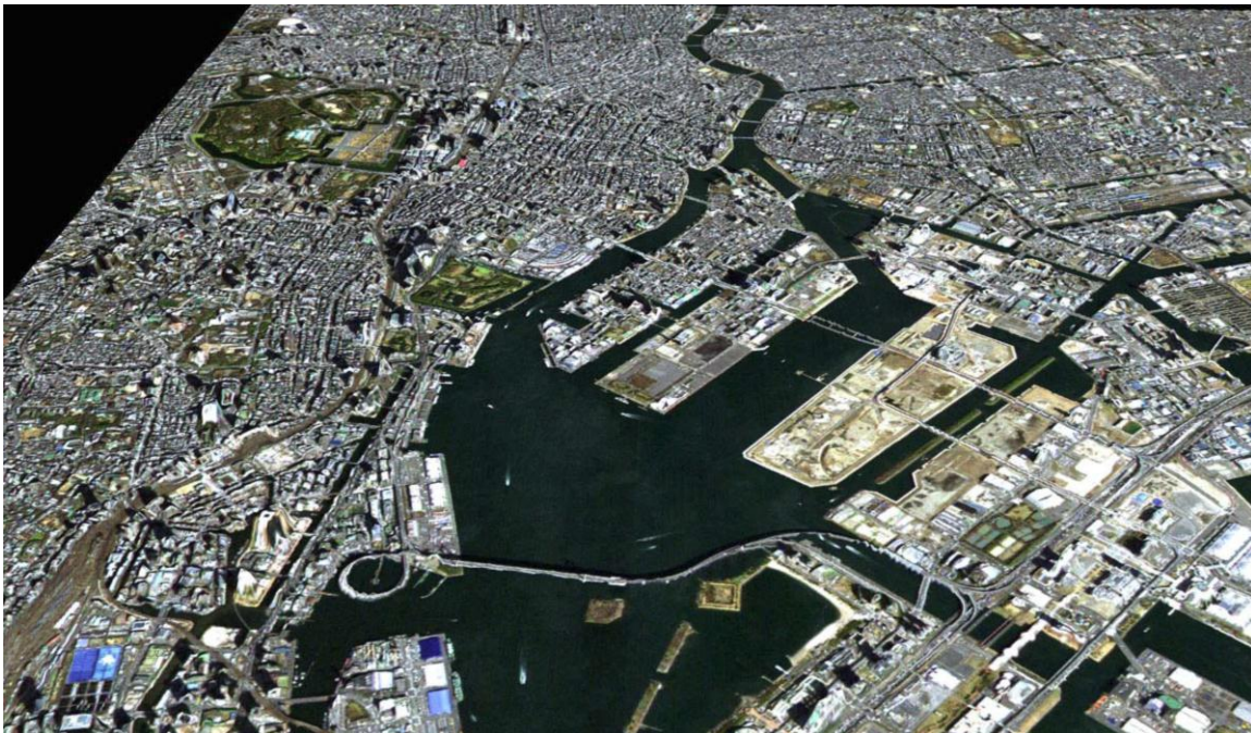
Εικόνα 15- Παράδειγμα δημιουργίας τρισδιάστατου μοντέλου πόλης με τη χρήση τριπλέτας PRISM για την παραγωγή DSM
