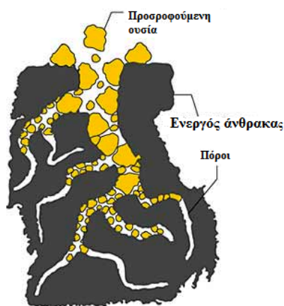
Σχήμα 1.4 Προσρόφηση σε πόρους ενεργού άνθρακα [2].
