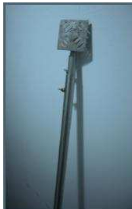
Εικόνα_10: Ειδικός μηχανισμός για την τοποθέτηση των στόχων σε ψηλά σημεία
