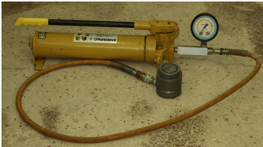
Σχήμα 5.2. Μανόμετρο (Ekerman) που χρησιμοποιήθηκε για τη βαθμονόμηση του δυναμόμετρου.
