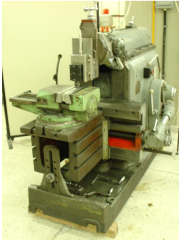
Σχήμα 5.30. Οριζόντια μηχανική ταχυπλάνη Εργαστηρίου Εξόρυξης Πετρωμάτων Ε.Μ.Π.
