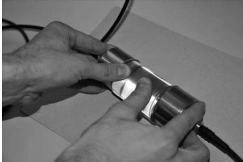
Σχήμα 6.19. Μηδενισμός της συσκευής PUNDIT (Proceq Pundit Lab Operating Instructions 2010).
