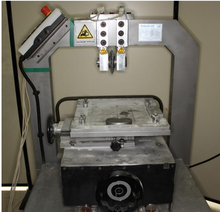
Σχήμα 5.1. Μηχανή δοκιμής κοπής με κοπτικό τύπου δίσκου του Εργαστηρίου Εξόρυξης Πετρωμάτων Ε.Μ.Π.
