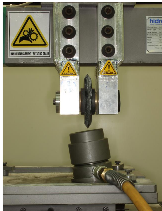
Σχήμα 5.6. Τοποθέτηση του εμβόλου για τη βαθμονόμηση (calibration) των δυνάμεων F_N και F_S .
