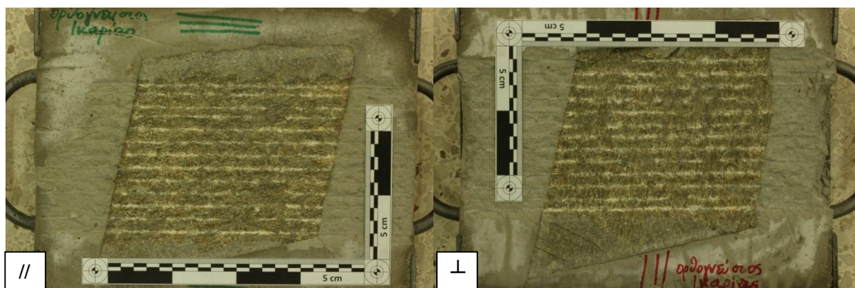
Σχήμα 5.9. Το δοκίμιο 01 (//) και το δοκίμιο 02 ( \perp ) μετά τη διαμόρφωση (trimming) της επιφάνειάς τους.
