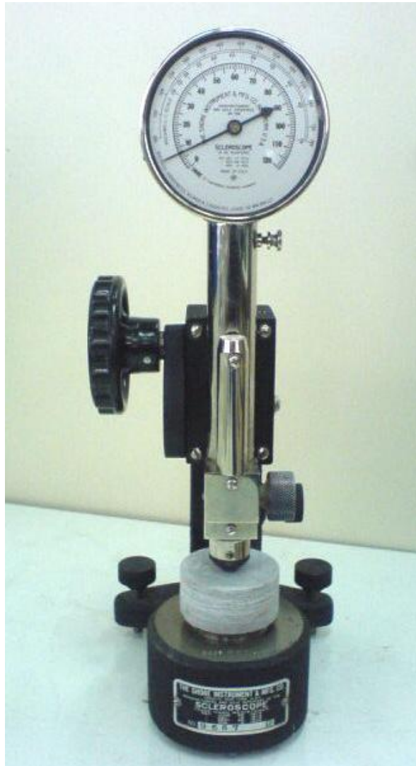
Σχήμα 6.10. Πειραματική συσκευή Shore (D model), η οποία χρησιμοποιήθηκε για την εκτέλεση της δοκιμής.
