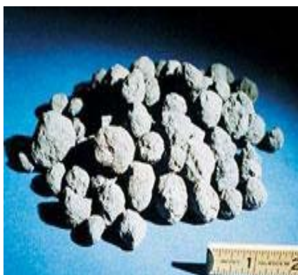
Εικόνα 1. 6: Σφαιρίδια (pellets) μεγέθους 15-25 mm του κλίνκερ τοιμέντου (προϊόν της διεργασίας πυροσυσσωμάτωσης στην περιστροφική κάμινο)
