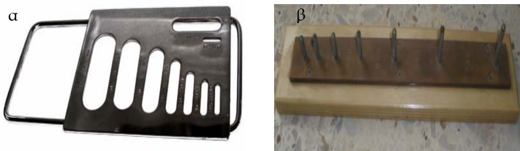
Εικόνα 4. 1: Μετρητικές συσκευές για τον προσδιορισμό του δείκτη «πλακωδών» τεμαχίων και του δείκτη «επιμήκους» τεμαχίων
