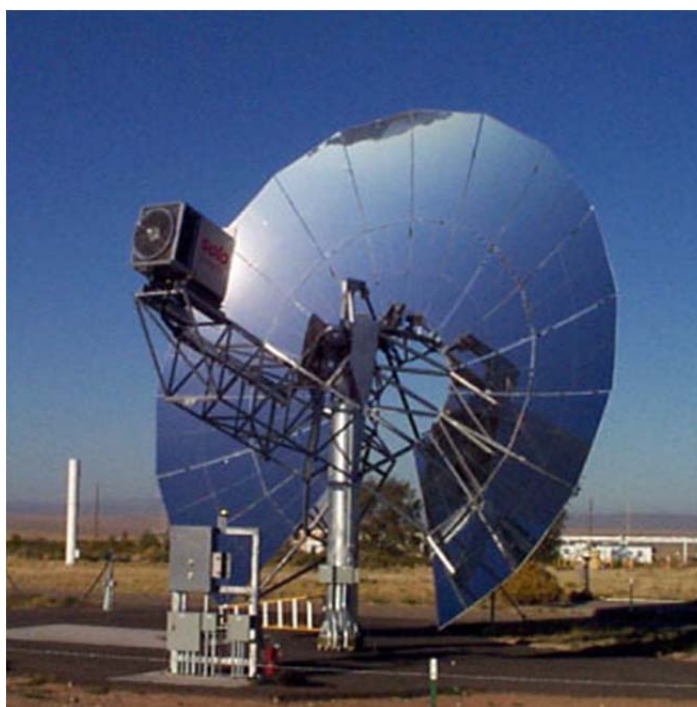
Σχήμα 1.18 Τυπικό Σύστημα Δίσκου-Μηχανής. [26]
