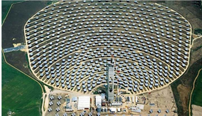
Σχήμα 4.1 Διάταξη Ηλιοστατικού Πεδίου Βόρεια του Πύργου PS10. [49]
