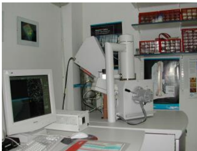
Σχήμα 8.5: Ηλεκτρονικό μικροσκόπιο σάρωσης Quanta 200
