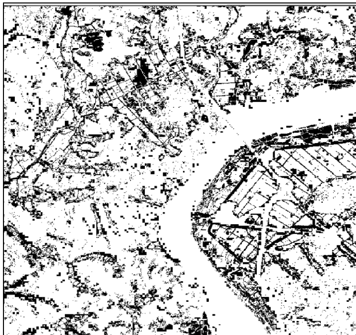
Εικόνα 31 : Εικόνα που δείχνει την συμφωνία των pixels στην ταξινόμηση των εικόνων Landsat και IKONOS. Τα μαύρα pixels (το 21% της εικόνας) ταξινομήθηκαν διαφορετικά στις δυο εικόνες. Τα λευκά pixels κατατάχθηκαν στην ίδια τάξη.
