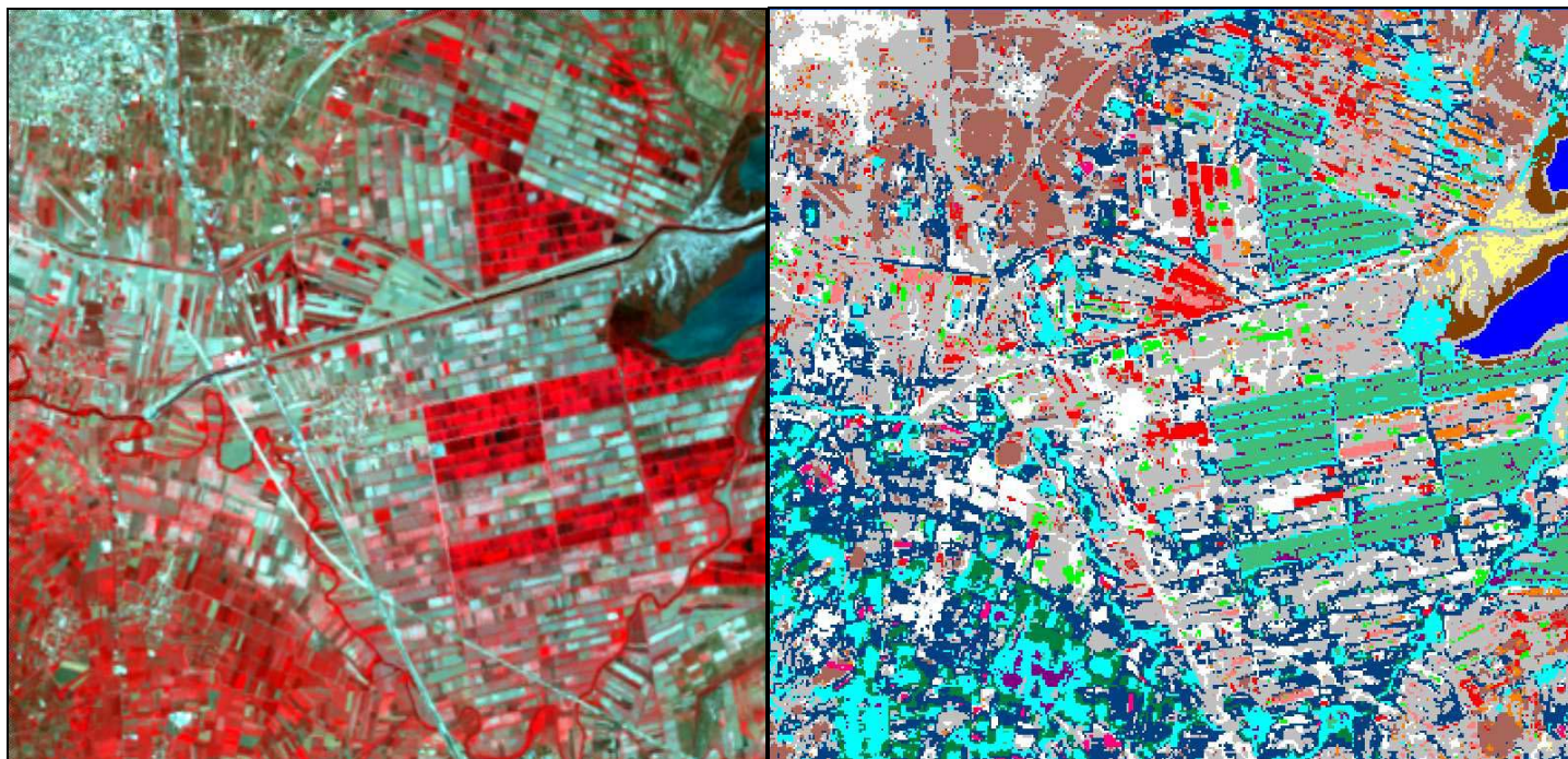
Εικόνα 58: Αριστερά το ψευδέγχρωμο σύνθετο 4,3,2 (R,G,B) της πολυφασματικής εικόνας Landsat TM της 14ης Απριλίου 2007, με κόκκινο χρώμα τονίζεται η βλάστηση και στην περίπτωση της περιοχής μελέτης οι καλλιέργειες. Δεξιά ο 16 τάξεων ταξινομημένος χάρτης που παράχθηκε από την εικόνα Landsat TM, της 14ης Απριλίου 2007 με τη χρήση του επιβλεπόμενου ταξινομητή της Μεγίστης Πιθανοφάνειας.
