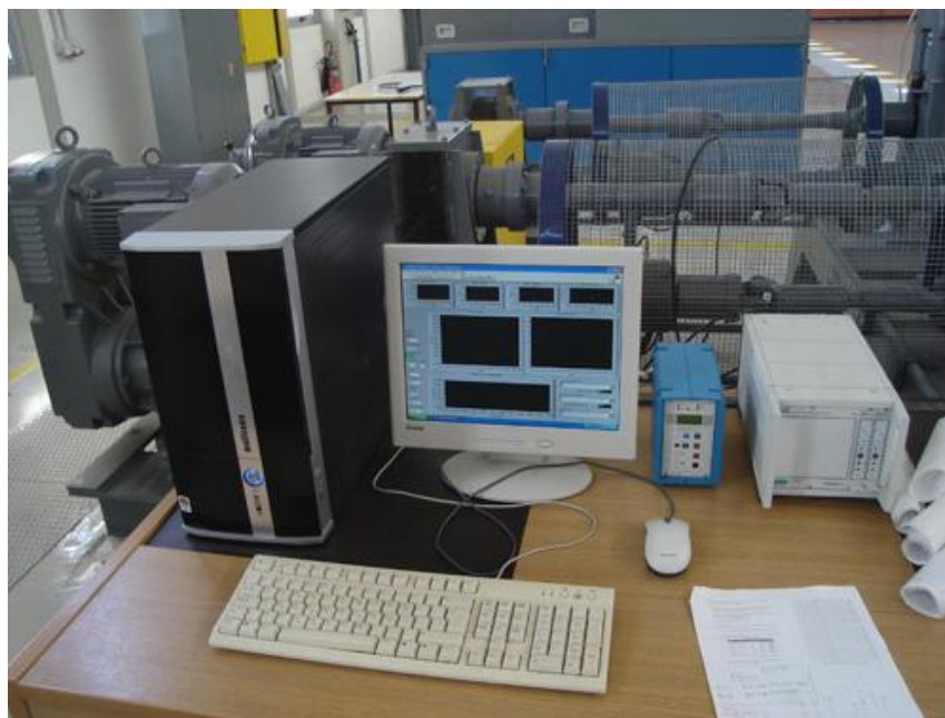
Σχ. 4.3: Φωτογραφία της μετρητικής διάταξης με τον ενισχυτή τού δυναμομέτρου (μπλε) και του ροπομέτρου (άσπρο) .
