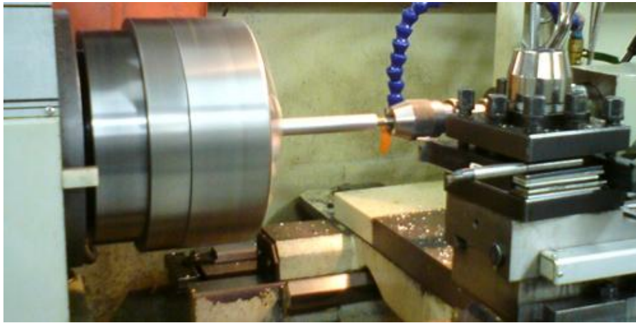
Σχ. 4.6: Φωτογραφία κατά την κατασκευή των δοκιμίων σε τόρνο.
