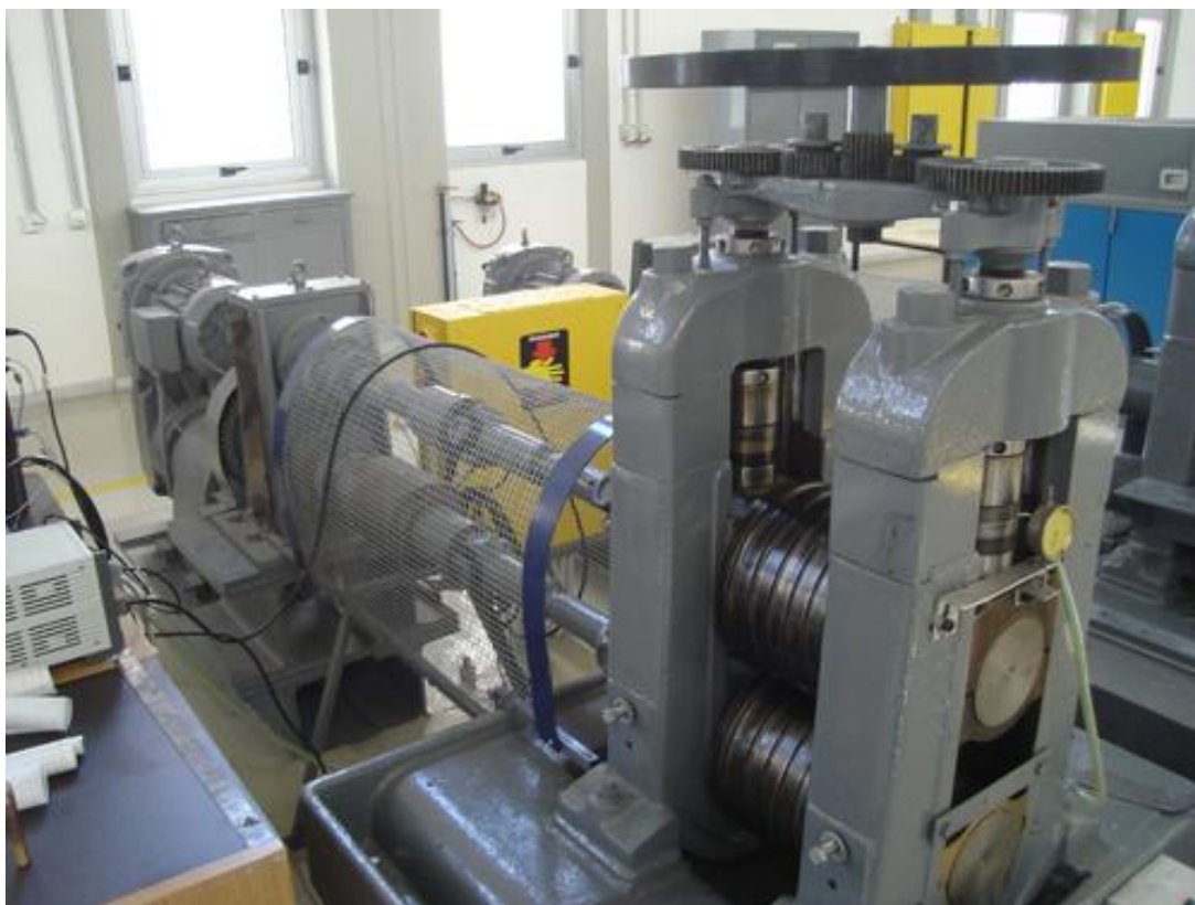
Σχ. 4.1: Φωτογραφία όλης της διάταξης τού ελαστρού.
