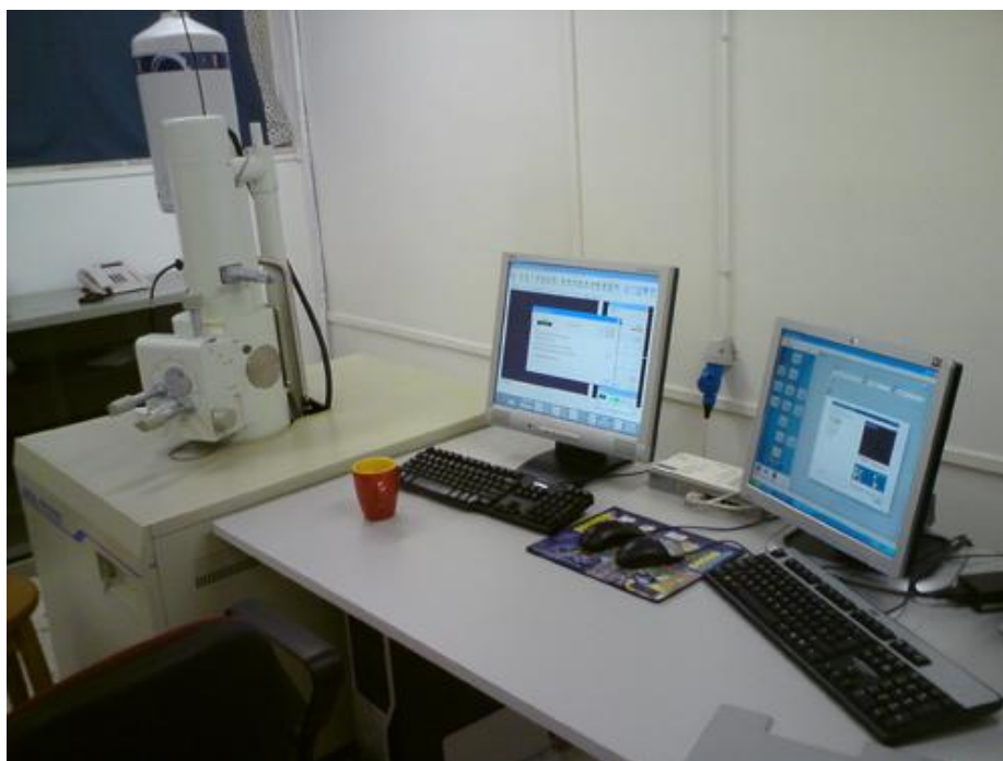
Σχ. 4.5: Φωτογραφία της διάταξης τού ηλεκτρονικού μικροσκοπίου σάρωσης.
