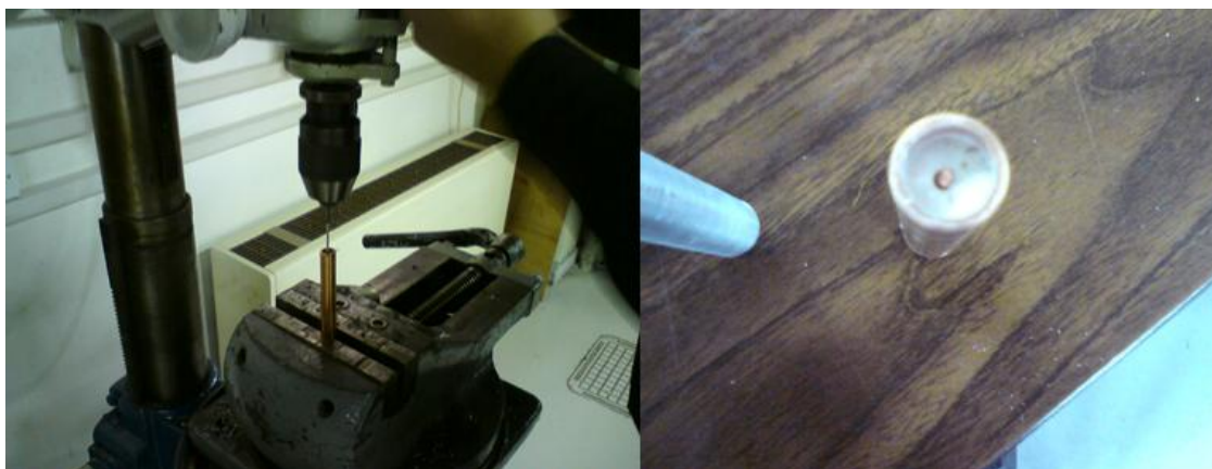
Σχ. 4.7: Φωτογραφία διάτρησης ορισμένων δοκιμών για τοποθέτηση σύρματος Cu και τελική μορφή.
