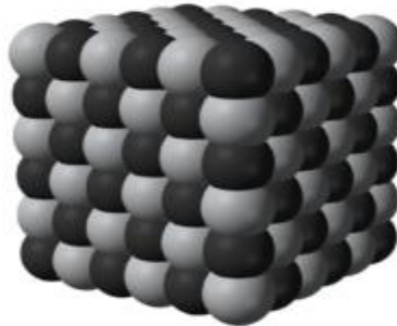
Σχ. 3.7: Η κρυσταλλική δομή του TiC.
