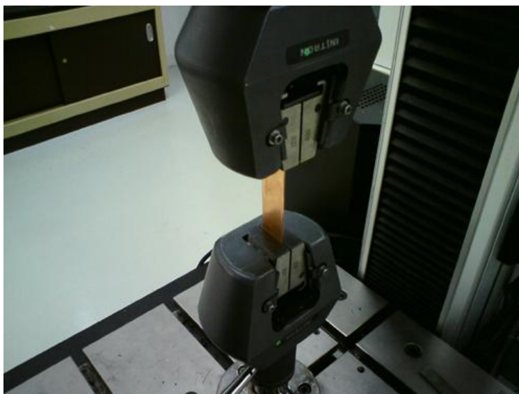
Σχ. 4.11: Φωτογραφία διάταξης μηχανικών δοκιμών (εφελκυσμού) INSTRON.
