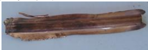
Σχ. 4.9: Φωτογραφία δοκιμίου μετά το πέρασμα ανάμεσα στα ράουλα, με τις προεξοχές που δημιουργούνται και πρέπει να αφαιρεθούν.
