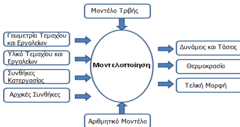
Σχ. 5.1: Τυπικός τρόπος μοντελοποίησης κατεργασίας διαμόρφωσης.
