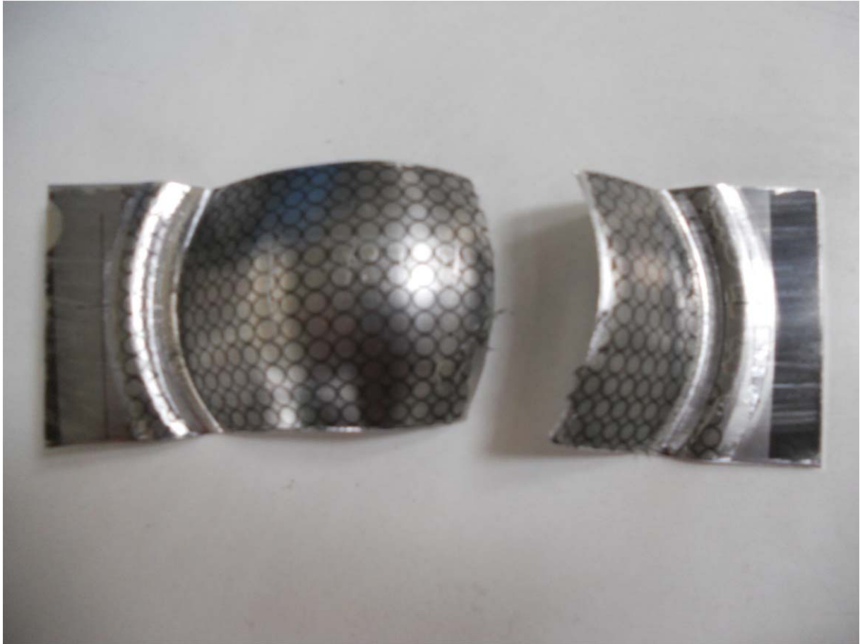
Σχήμα 6.18 : Δοκίμιο κράματος αλουμινίου μετά τη διαμόρφωση. Το δοκίμιο έχει αστοχήσει στο δεξιό μέρος και στο αριστερό έχει παρουσιαστεί λαιμός.
