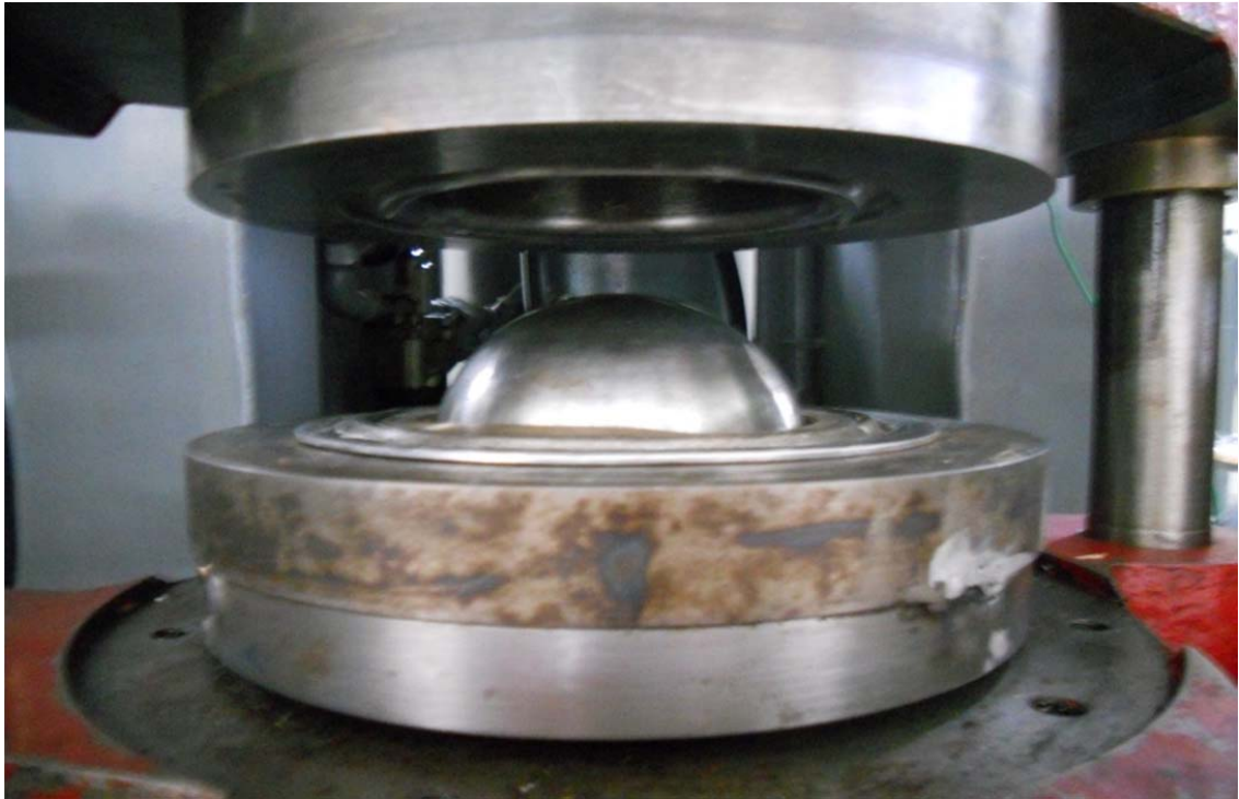
Σχήμα 6.3 : Φωτογραφική άποψη της διάταξης της καταργασίας , τοποθετημένης στην πρέσα
