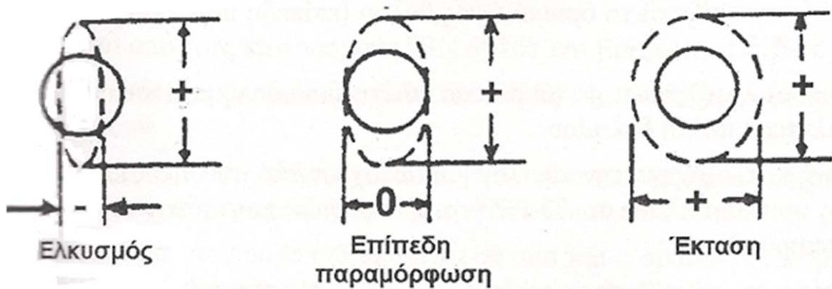
Σχήμα 5.3 : Τρόποι παραμόρφωσης των κύκλων του πλέγματος κατά τις δοκιμές διαμορφοσιμότητας
