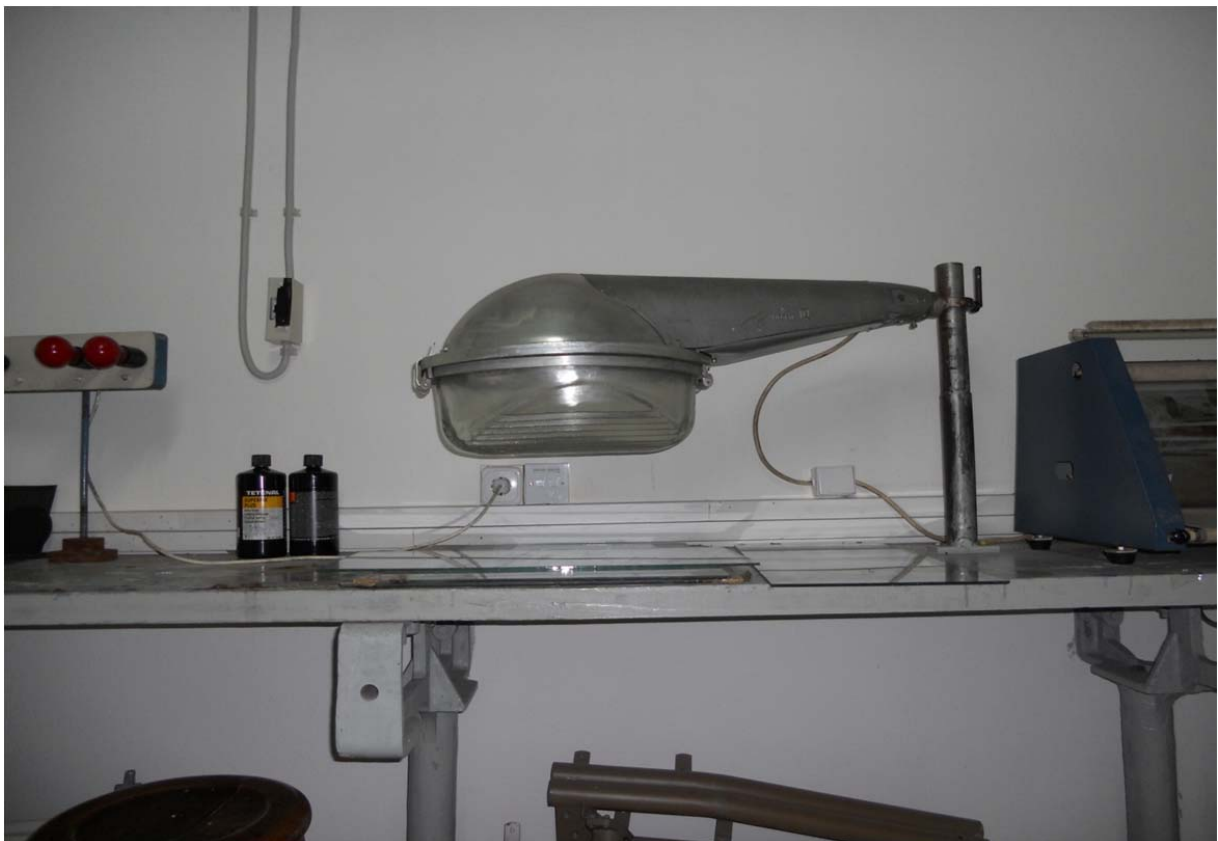
Σχήμα 6.12 : Φωτογραφική άποψη λάμπας έκθεσης. Αριστερά διακρίνονται οι λάμπες κόκκινου μονοχρωματικού φωτός.
