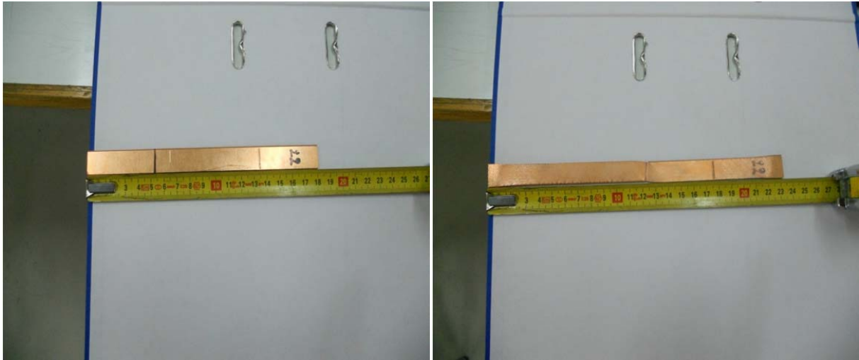
Σχήμα 6.8 : Φωτογραφική άποψη δοκιμίου χαλκού πριν και μετά κατα τη διεξαγωγή του μονοαξονικού εφελκυσμού
