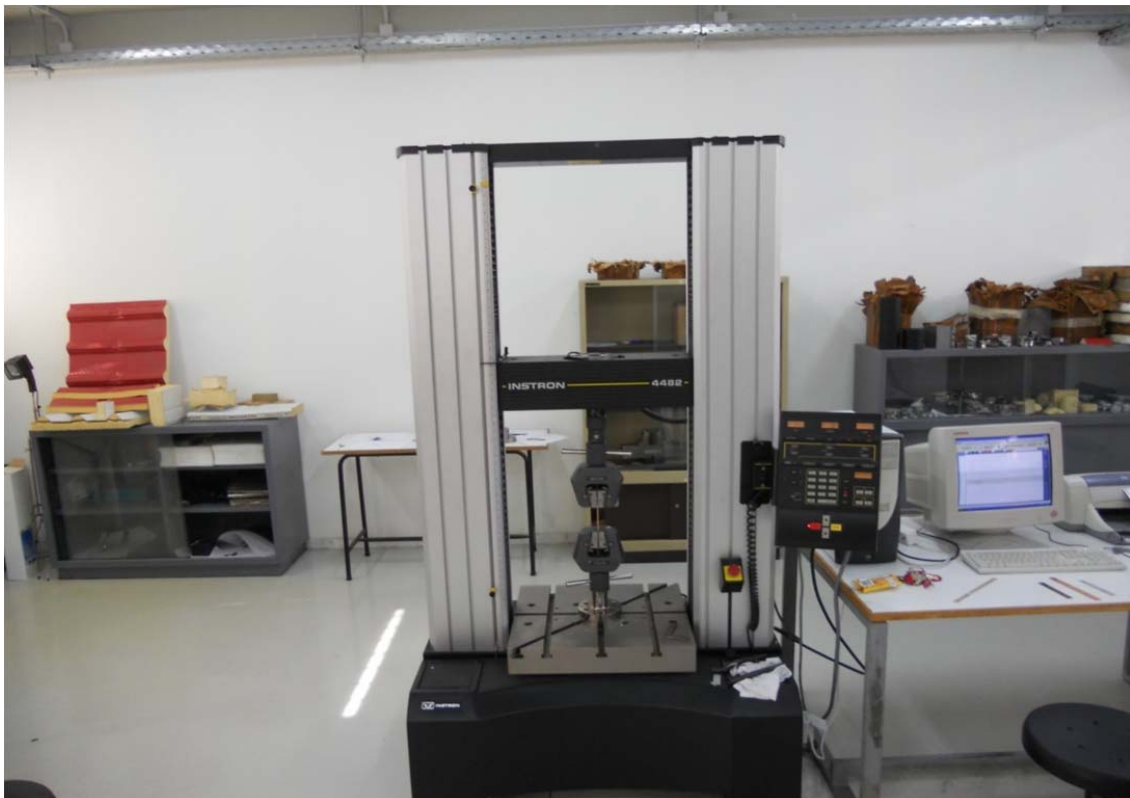
Σχήμα 6.7 : Φωτογραφική άποψη δοκιμής μονοαξονικού εφελκυσμού στο εργαστήριο για την εξαγωγή των καμπυλών \sigma - \epsilon
