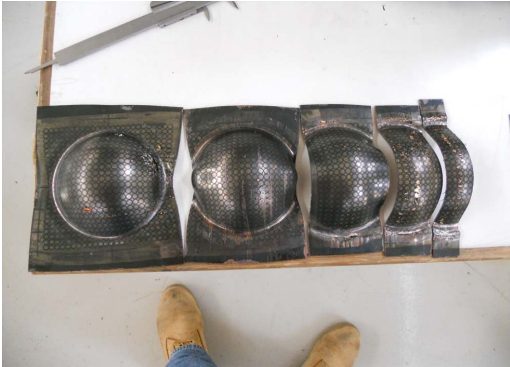
Σχήμα 6.17 : Δοκίμια χαλκού πάχους 2 mm μετά τη διαμόρφωση
