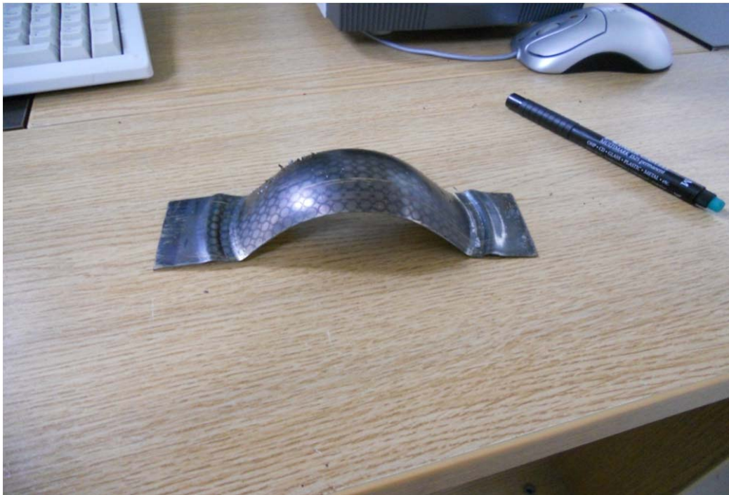
Σχήμα 6.17 : Δοκίμιο ορείχαλκου πάχους 1 mm μετά τη διαμόρφωση
