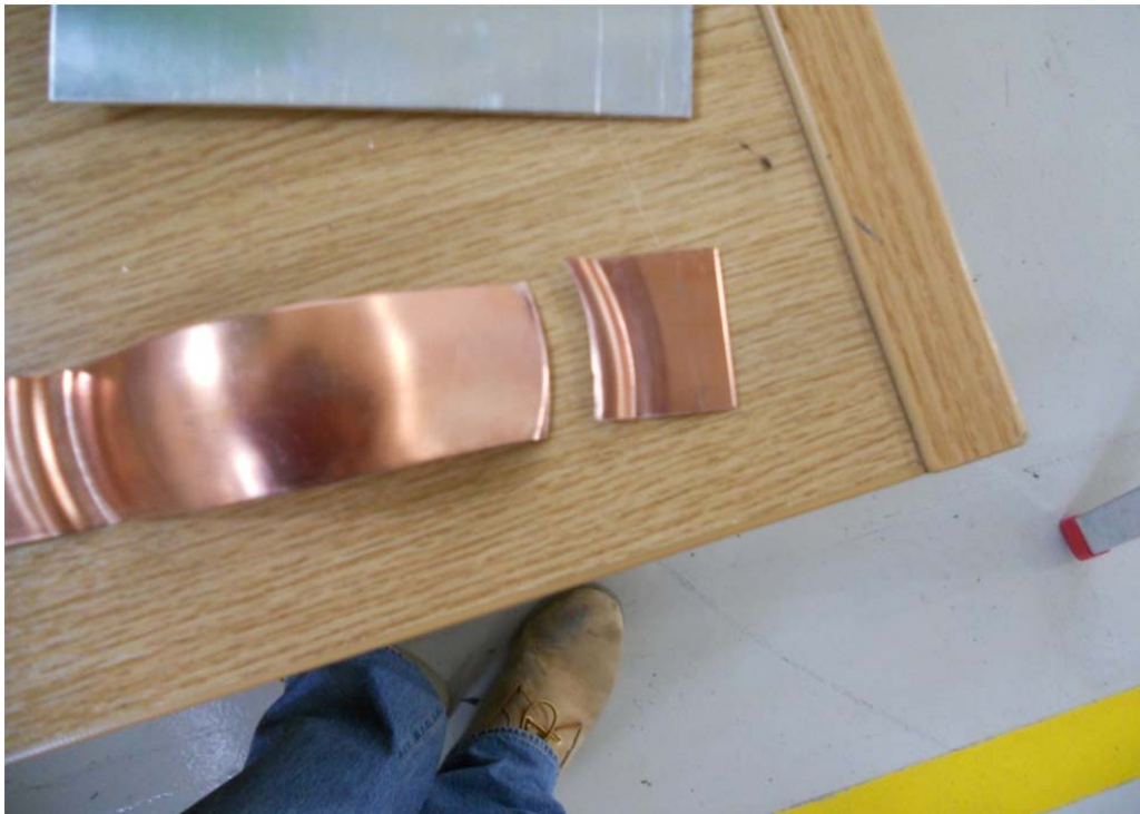
Σχήμα 6.16 : Δοκίμιο που αστόχησε λόγω συγκράτησης
