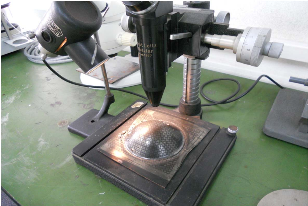
Σχήμα 6.6 : Φωτογραφική άποψη μικροσκοπίου εργαστηρίου κατά την μέτρηση των παραμορφώσεων
