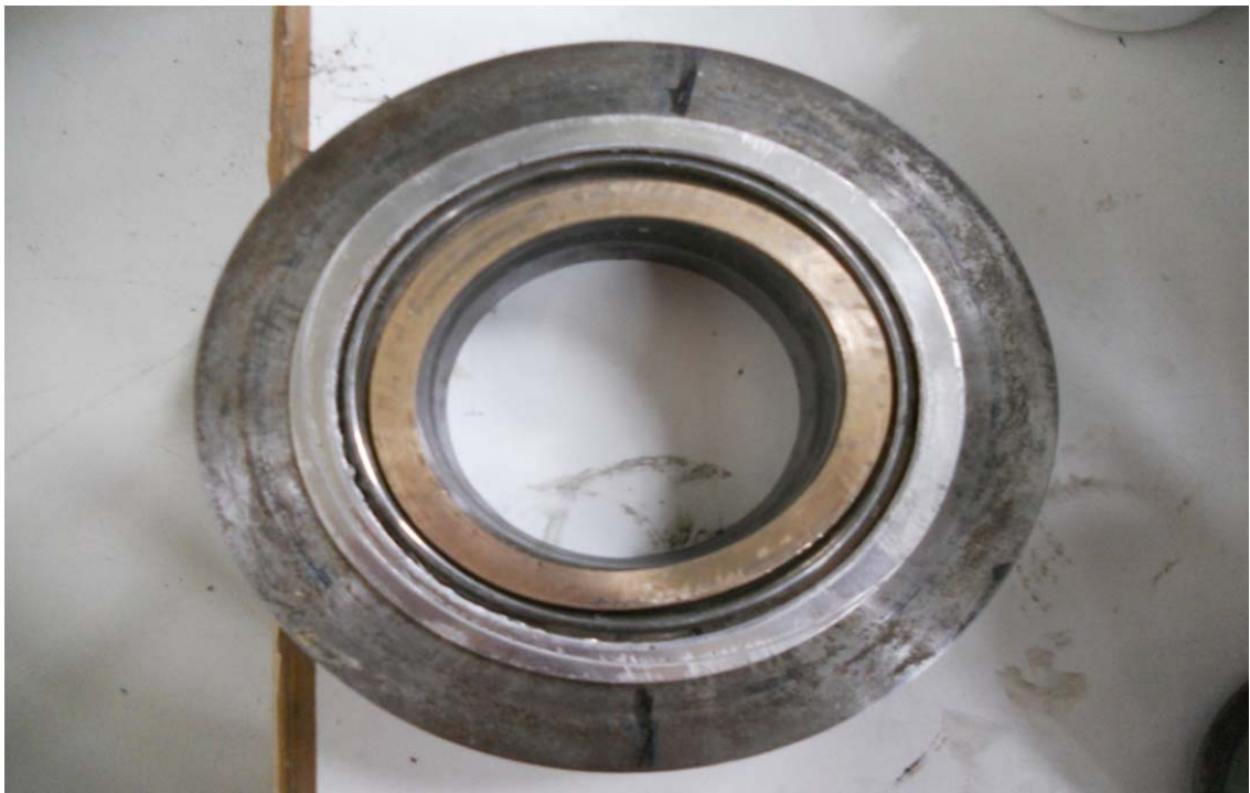
Σχήμα 6.4 : Φωτογραφική άποψη της μήτρας. Διακρίνονται το χείλος και τα δακτυλίδια συγκράτησης
