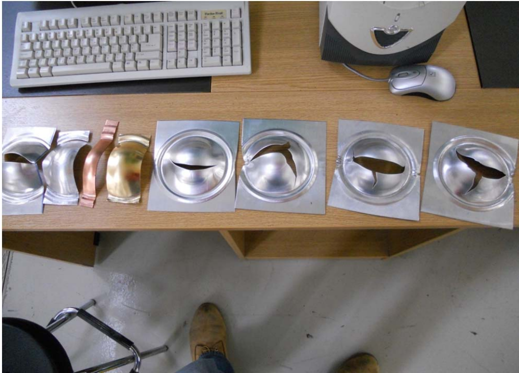
Σχήμα 6.15 : Δοκιμαστικές διαμορφώσεις για τον καθορισμό της συγκράτησης
