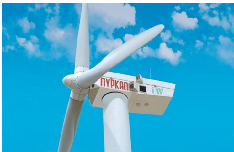
Εικόνα 5.1:Ανεμογεννήτρια 600KW κατασκευής ΠΥΡΚΑΛ (Πηγή: www.eas.gr/ )
