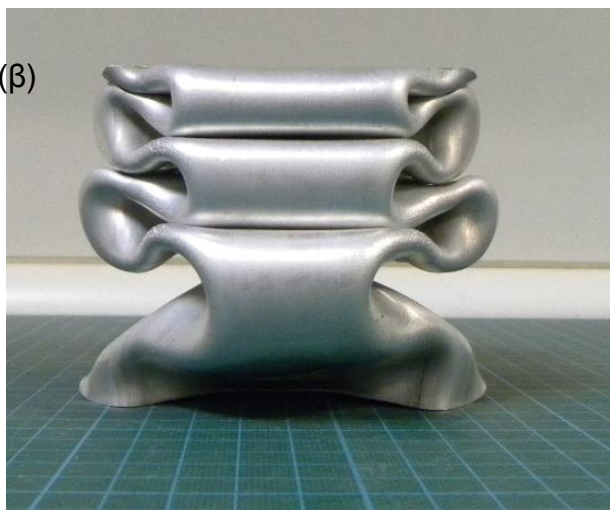
Εικόνα 29: (α) Στιγμιότυπα από την κατάρρευση του δοκιμίου όπως προκύπτουν από την ανάλυση με πεπερασμένα στοιχεία και (β) μορφολογία δοκιμίου μετά το πέρας της πειραματικής δοκιμής.
