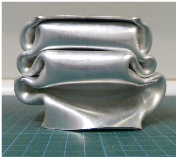
Εικόνα 35: (α) Στιγμιότυπα από την κατάρρευση του δοκιμίου όπως προκύπτουν από την ανάλυση με πεπερασμένα στοιχεία και (β) μορφολογία δοκιμίου μετά το πέρας της πειραματικής δοκιμής.
