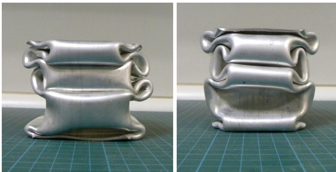
Εικόνα 31: μορφολογία δοκιμίου μετά το πέρας της πειραματικής δοκιμής.
