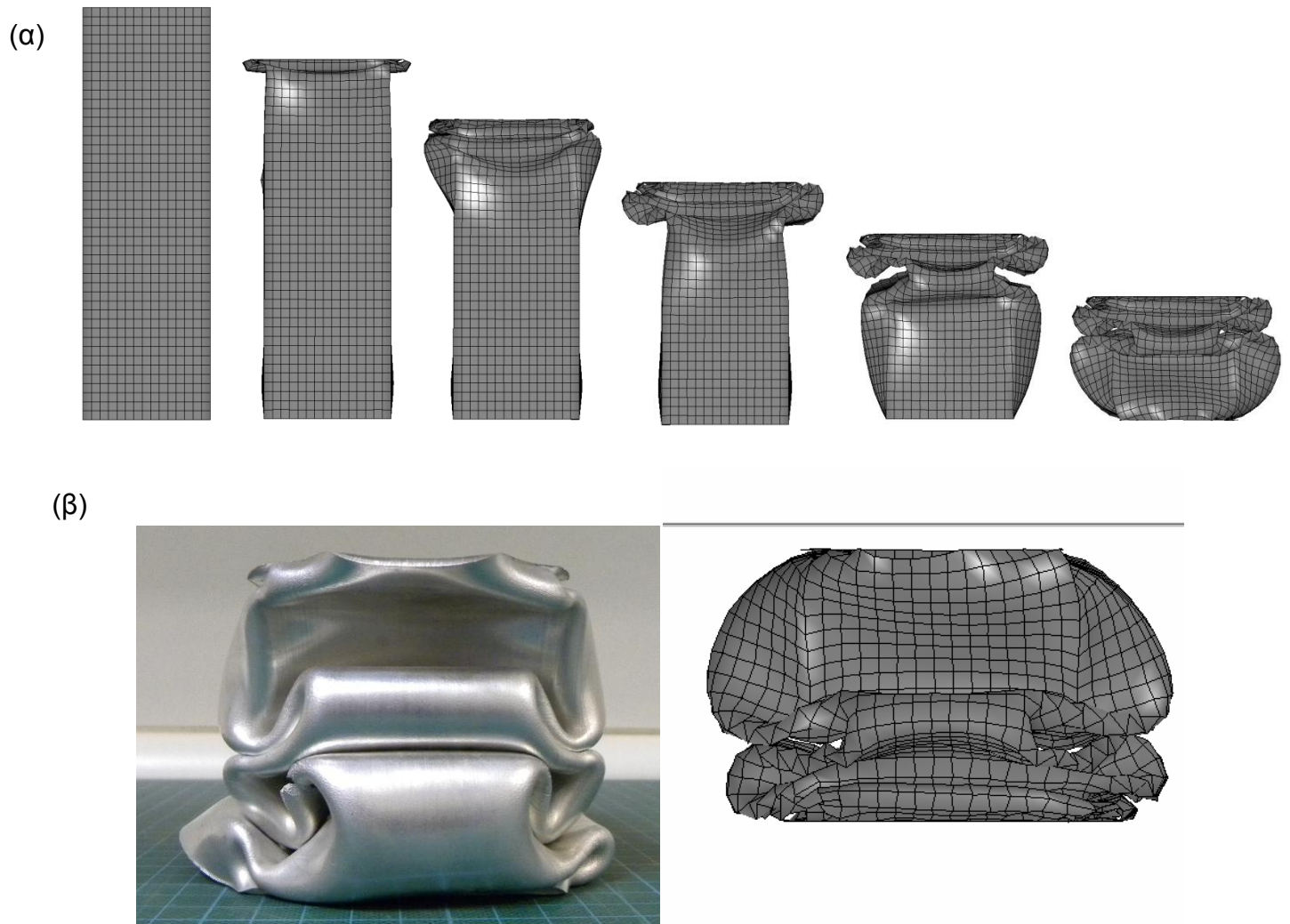
Εικόνα 41: (α) Στιγμιότυπα από την κατάρρευση του δοκιμίου όπως προκύπτουν από την ανάλυση με πεπερασμένα στοιχεία και (β) μορφολογία δοκιμίου μετά το πέρας της πειραματικής δοκιμής.
