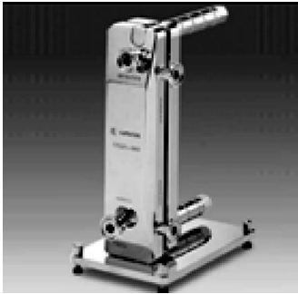
Σχήμα 33: Το κελί της μεμβράνης υπερδιήθησης κατασκευασμένο από ανοξείδωτο χάλυβα.
