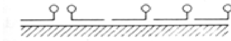
Σχήμα 10: Μηχανισμός προσρόφησης μέσω δυνάμεων διασποράς
