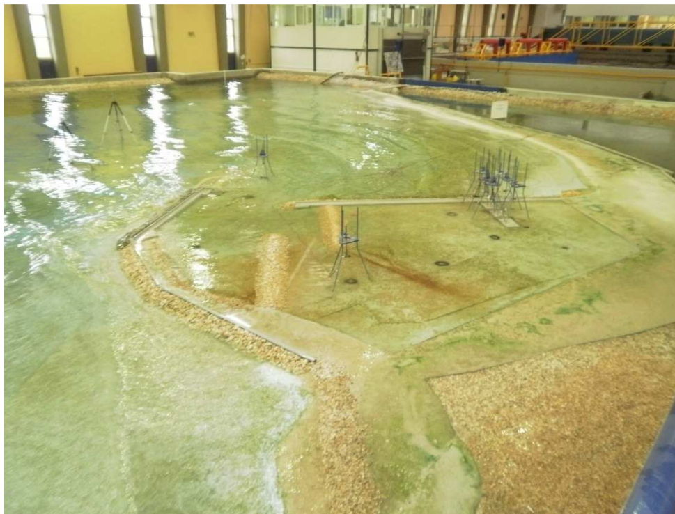
Φωτογραφία 4.1 – Διάταξη 1. Παρουσία δύο εσωτερικών παράλληλων προβόλων με φυσικούς ογκόλιθους.
