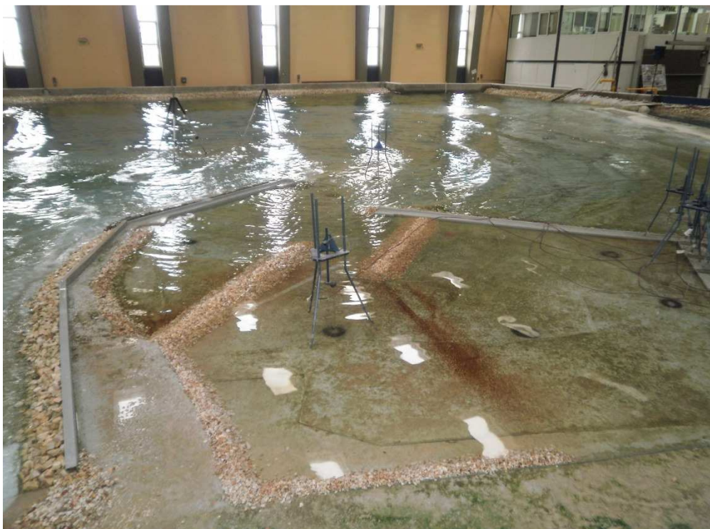
Φωτογραφία 4.2 – Διάταξη 2. Διάταξη 2. Παρουσία δύο εσωτερικών παράλληλων προβόλων με φυσικούς ογκόλιθους και τμήμα εσωτερικής θωράκισης των κρηπιδωμάτων.
