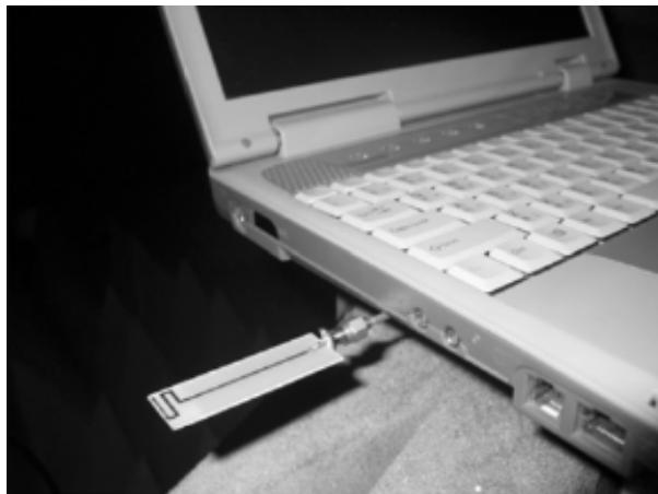
Εικόνα 1-2 Τυπωμένη μαιανδρική κεραία σε μία κάρτα USB-WLAN [2]
