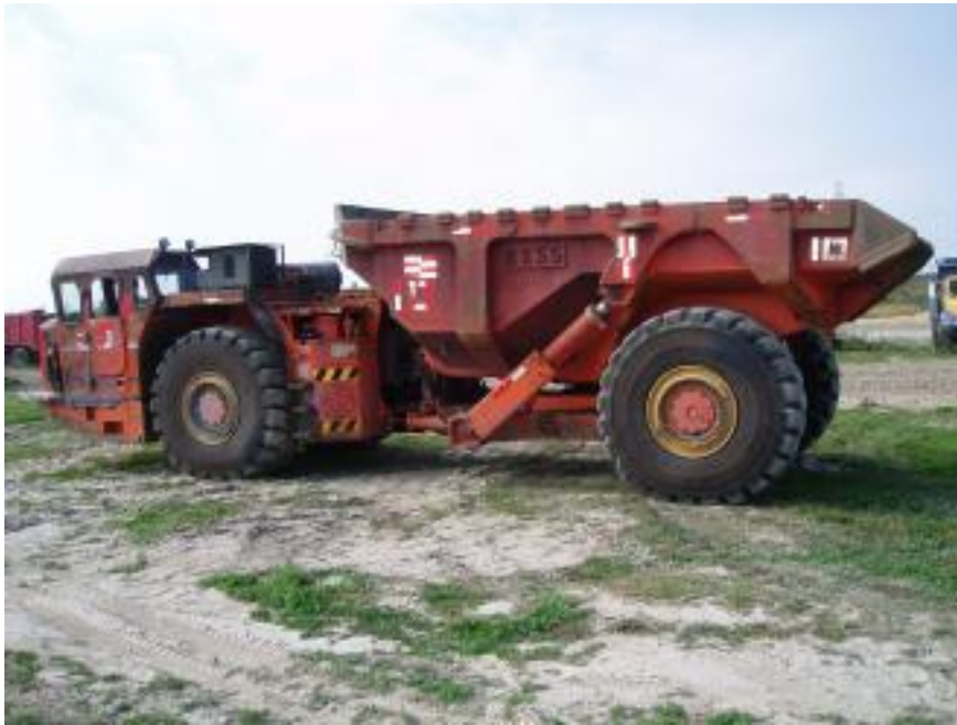
Εικόνα 7.18 Φορτωτής υπογείων μάρκας TORO χωρητικότητας 22m 3
