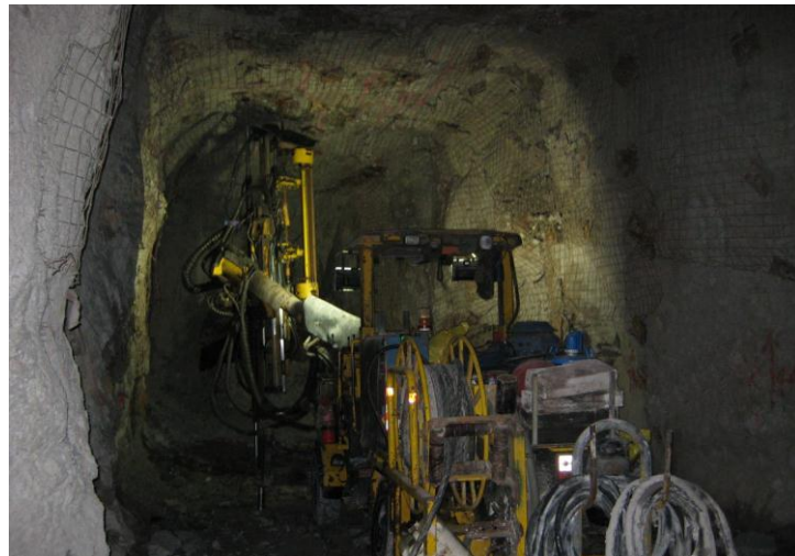
Εικόνα 9.5. jumbo κοχλιώσεως Secoma
