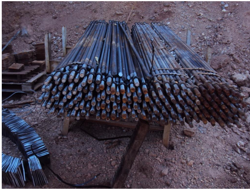
Εικόνα 7.15 Κοχλίες υποστήριξης τύπου MINOVA
