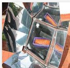
Εικόνα 3.6. Box cooker, με 4 γυαλιστερές επιφάνειες για αντανάκλαση φωτός
