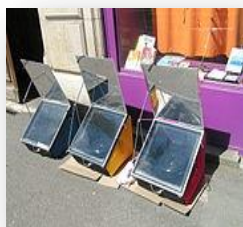
Εικόνα 3.5. Box cooker, με μία γυαλιστερή επιφάνεια για αντανάκλαση φωτός
