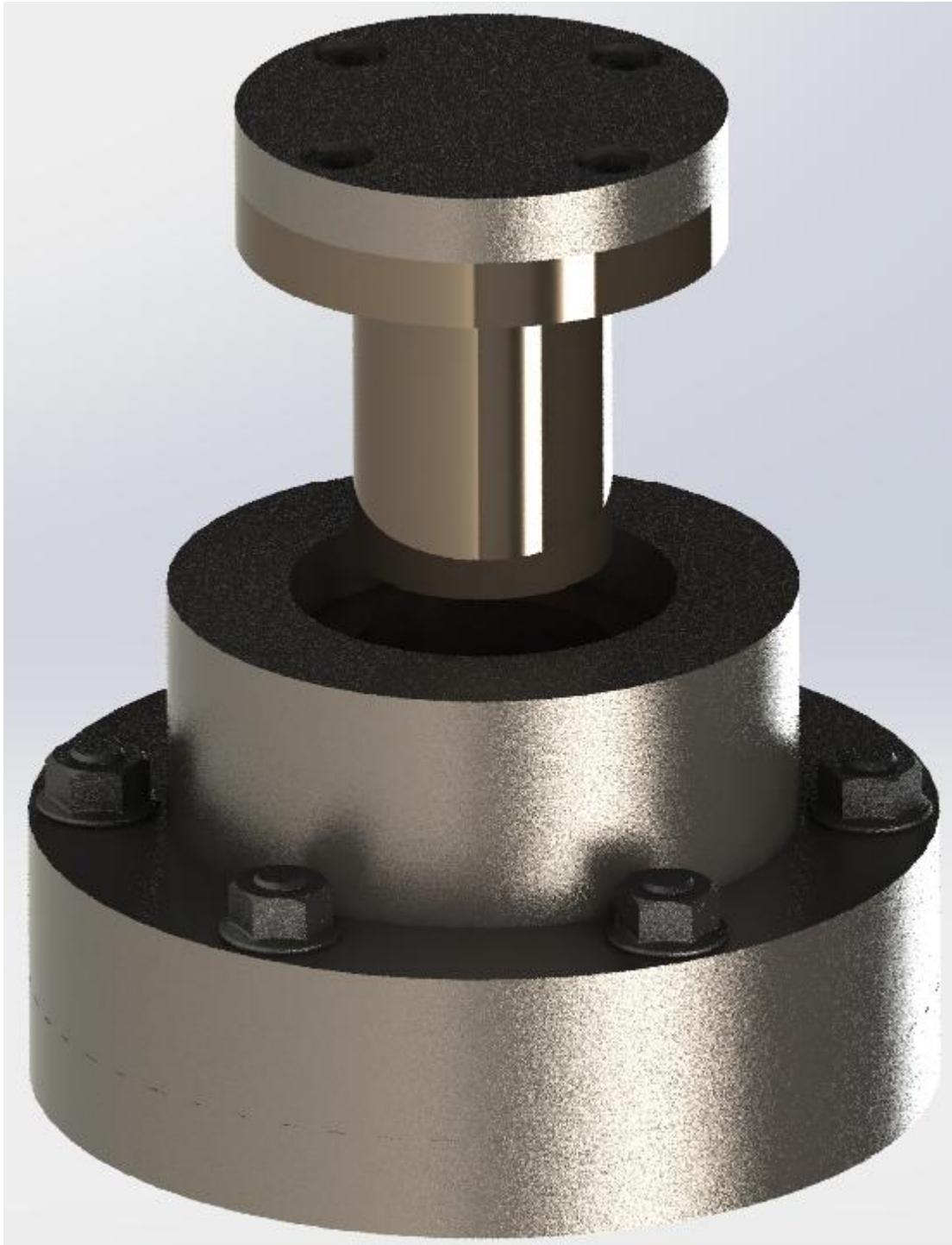
Σχήμα 5.9: Τρισδιάστατη απεικόνιση της μήτρας σφυρηλάτησης με κυλινδρικό έμβολο
