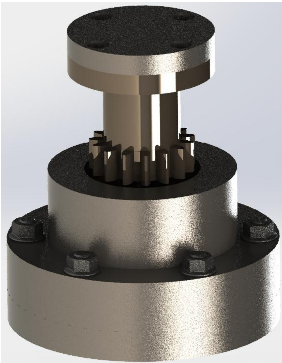
Σχήμα 5.12: Τρισδιάστατη απεικόνιση της μήτρας σφυρηλάτησης με έμβολο μορφής γραναζιού
