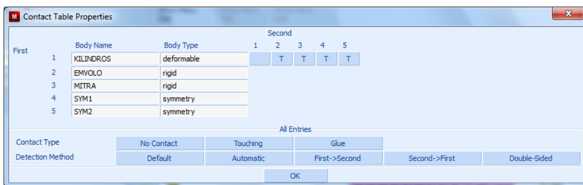
Σχήμα 5.27: Ορισμός του πίνακα επαφών μεταξύ των στοιχείων
