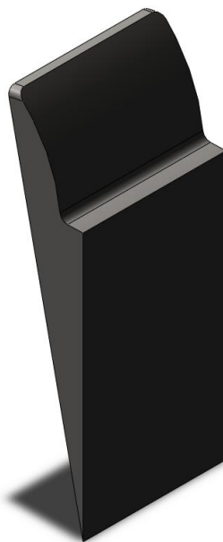
Σχήμα 5.3: Συμμετρικό τμήμα οδοντωτού τροχού που θα προσομοιωθεί
