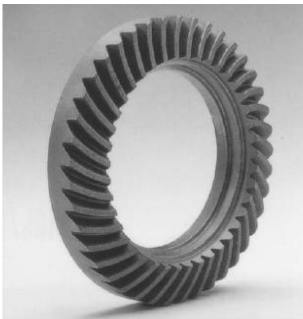
Σχήμα 3.10: Παράδειγμα σφυρήλατου οδοντωτού τροχού ακριβείας σχεδόν καθαρού σχήματος (ASM International 2005).
