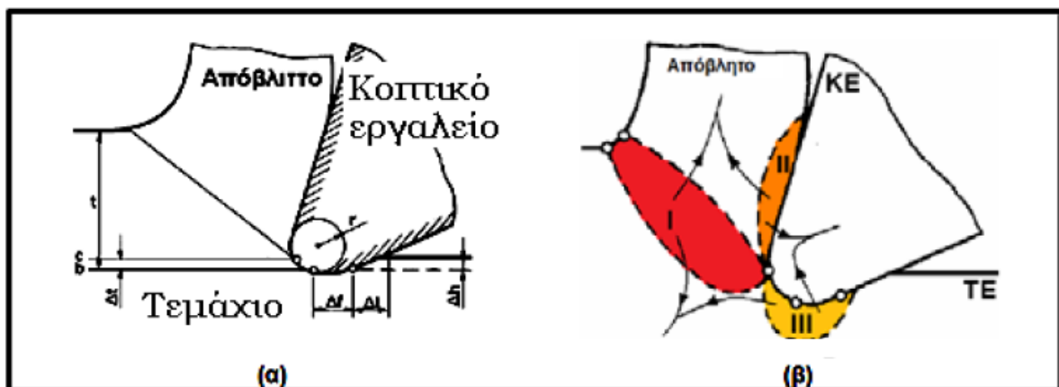
Σχήμα 1.7 Περιοχές παραγωγής θερμότητας κατά την κοπή και η συμβολή κάθε ζώνης στη διανομή της θερμότητας
