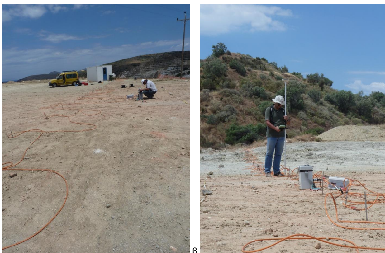
Σχήμα 4.18. α) Ηλεκτρόδια, καλώδια, γεωηλεκτρικό όργανο κατά την διάρκεια μέτρησης της τομής γεωηλεκτρικής τομογραφίας «MIL-RES-2», β) Ακριβείς μετρήσεις θέσης και υψομέτρου των ηλεκτροδίων τομής γεωηλεκτρικής τομογραφίας με διαφορικό GPS.
