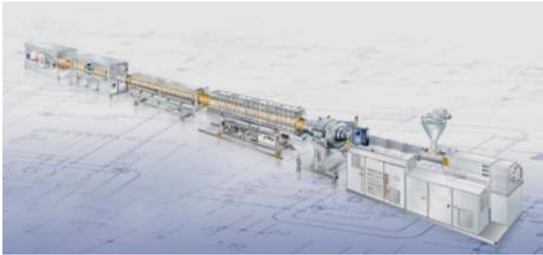
Σχήμα 1.4. Γραμμή παραγωγής πλαστικού σωλήνα με την μέθοδο της εκβολής υλικού
