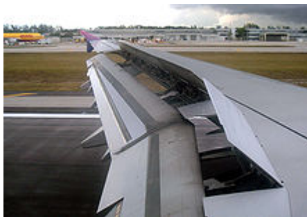
Σχήμα :Το σπόιλερ (τα σηκωμένα τμήματα) κατά την προσγείωση του Airbus A321 .
