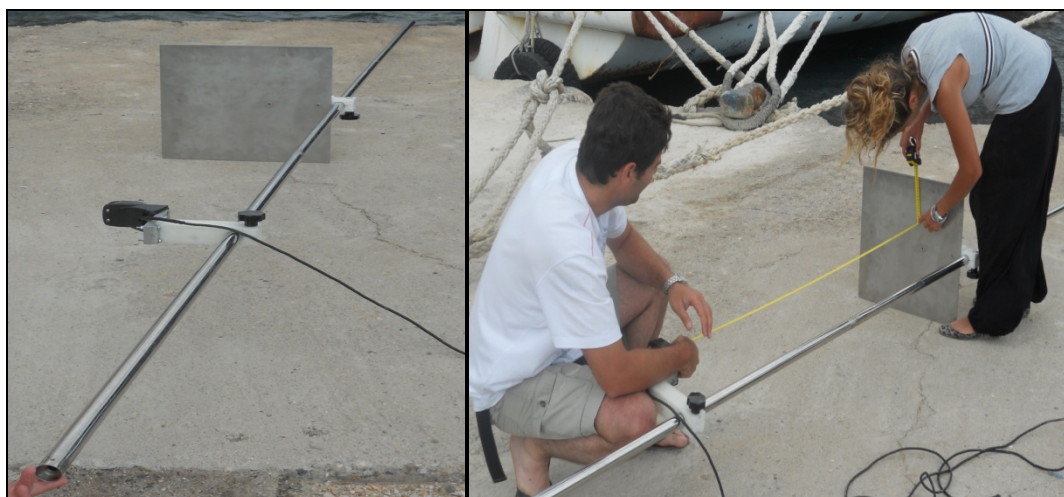
Εικόνα 5.6 2 η Μέρα μετρήσεων – Καλιμπράρισμα Ηχοβολιστικού Συστήματος
