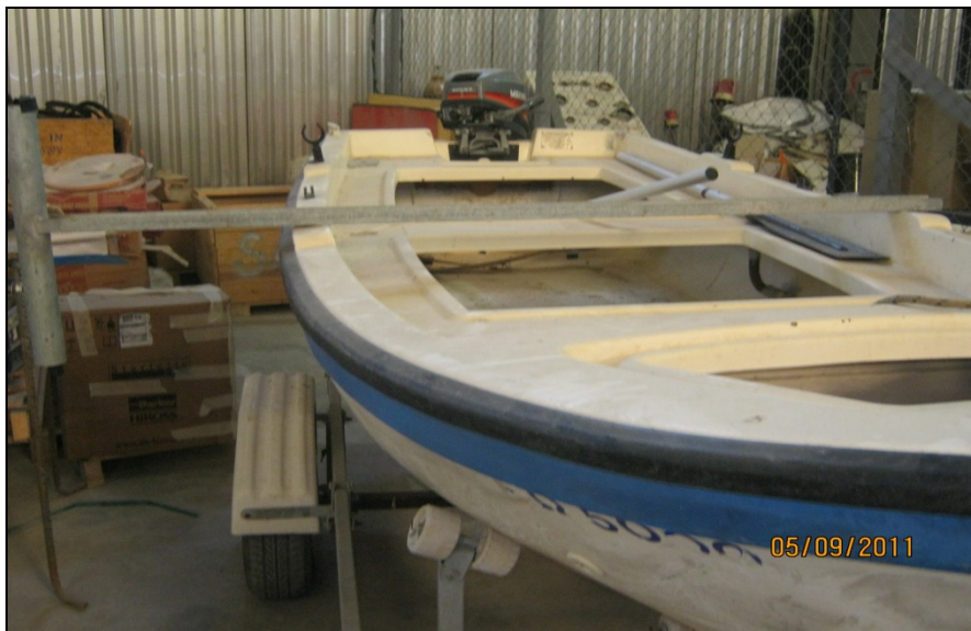
Εικόνα 4.4 Προσαρμογή μεταλλικής κατασκευής στην λέμβο
