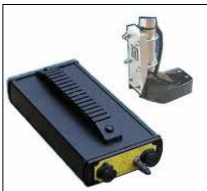
Εικόνα 4.2 Ηχοβολιστικό σύστημα SonarMite v3 (πηγή: http://www.survey-solutions-scotland.co.uk/ )
