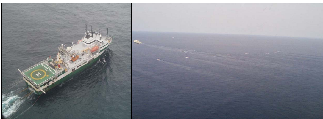
Εικόνα 1.7(α),(β) Σεισμικό ερευνητικό σκάφος (αριστερά), Ερευνητικό σκάφος, σεισμικές πηγές και απολήξεις σεισμικών καλωδίων (δεξιά)
