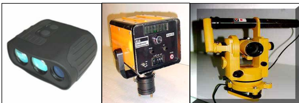
Εικόνα 2.3.(α),(β),(γ) Τηλέμετρο (αριστερά), EDM (μέση), Οπτικός θεοδόλιχος (αριστερά) (πηγή: Διπλωματική εργασία Κασκουρά Βασιλικής, http://dspace.lib.ntua.gr/ , http://www.astronomy.gr/ , http://www.google.gr/ )
