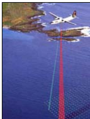
Εικόνα 2.16 Βυθοσκόπηση παράκτιων περιοχών με χρήση Αερομεταφερόμενου Βυθομέτρου Laser (πηγή: Β. Καψημάλη, 2009)
