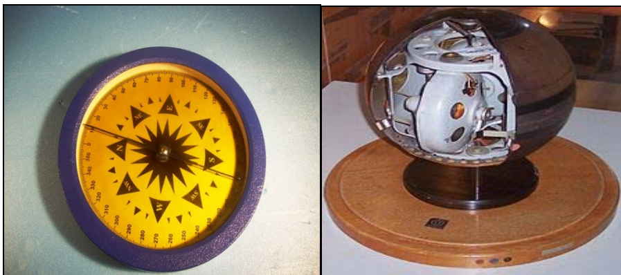
Εικόνα 2.1.(α),(β) Μαγνητική πυξίδα (αριστερά), Γυροσκοπική πυξίδα Anschütz (δεξιά) (πηγή: http://why.gr/ , http://el.wikipedia.org )
