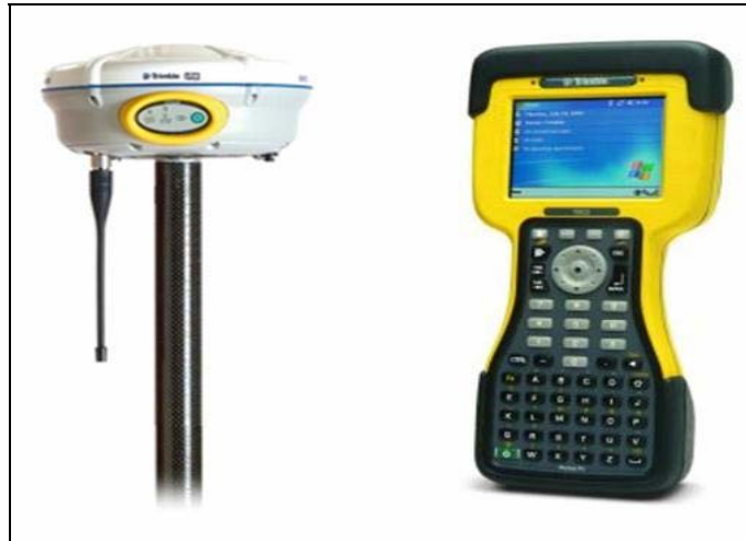
Εικόνα 4.1 Δέκτης GPS Trimble R8 (αριστερά), χειριστήριο (δεξιά) (πηγή: http://www.madsenlandsurveying.com/ )
