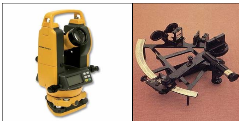
Εικόνα 2.2.(α),(β) Θεοδόλιχος (αριστερά), Εξάντας (δεξιά) (πηγή : http://www.google.gr/ , http://el.wikipedia.org/ )
