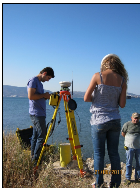
Εικόνα 5.3.(α) 1 η Μέρα μετρήσεων- Τοποθέτηση βάσης GPS
