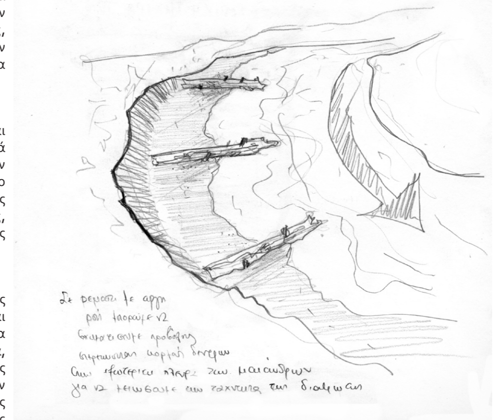
πρόβολοι από κορμούς δέντρων- προστασία από διάβρωση
