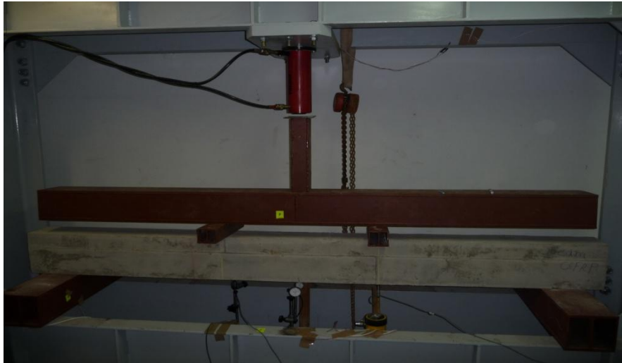
Σχήμα 4-9 Το μεταλλικό πλαίσιο, η πειραματική δοκός και το σύστημα φόρτισης
