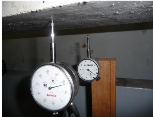
Σχήμα 4-5 Τα μηχανικά βελόμετρα για τη μέτρηση της βύθισης των δοκών
