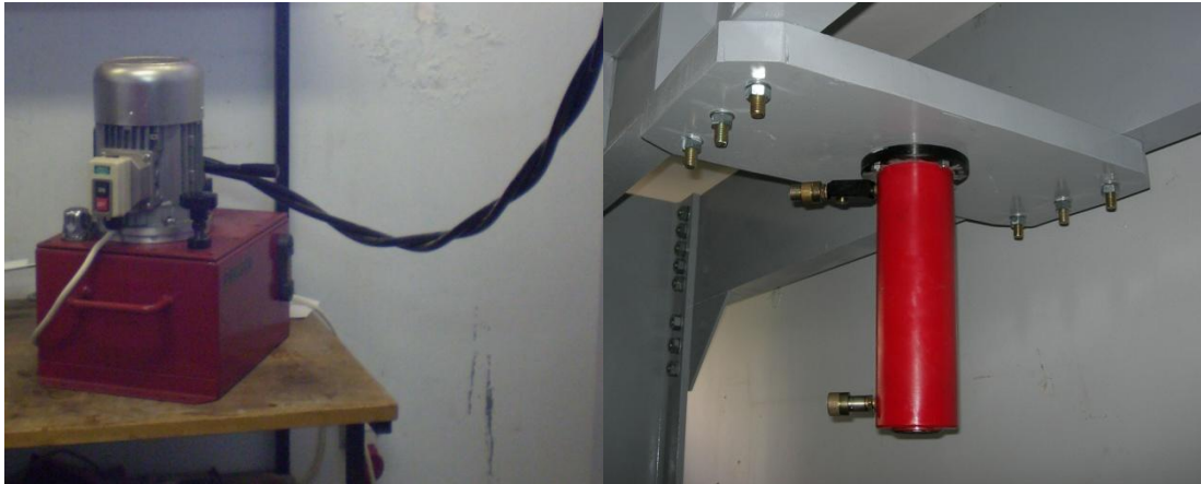
Σχήμα 4-11 (αριστερά) η ηλεκτρο-υδραυλική αντλία και σωλήνες υψηλής πίεσης και (δεξιά) το έμβολο διπλής κατεύθυνσης και ταχυσύνδεσμοι
