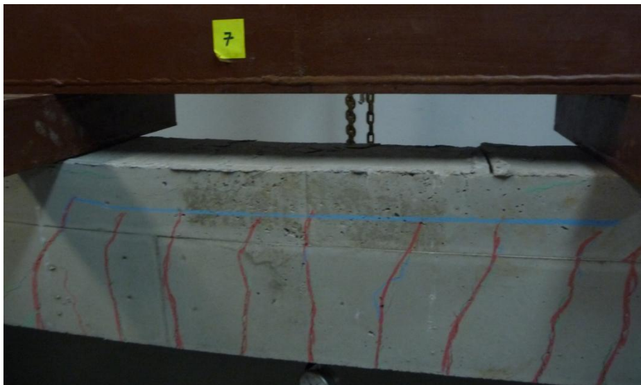
Σχήμα 4-15 Η θραύση στη δοκό με οπλισμό G-FRP
