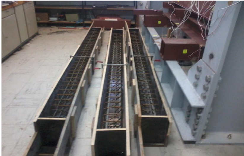
Σχήμα 4-1 Τα καλούπια πριν τη σκυροδέτηση
