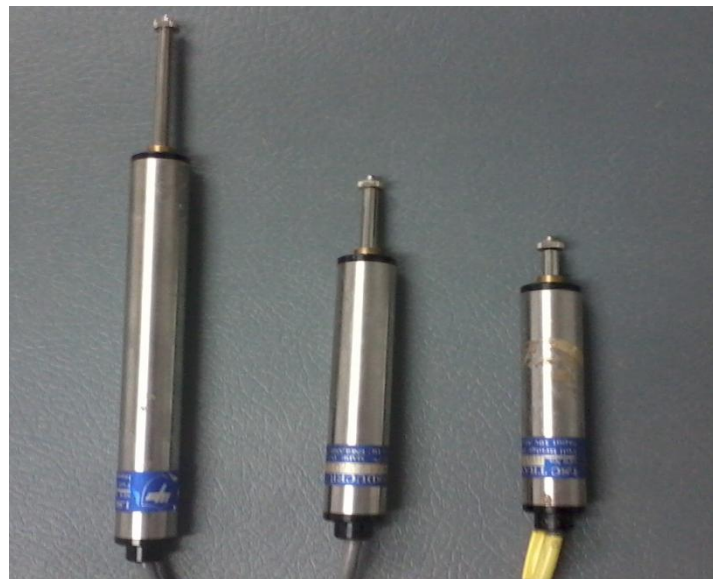
Σχήμα 4-6 Τα ηλεκτρονικά βελόμετρα για τη μέτρηση της βύθισης
