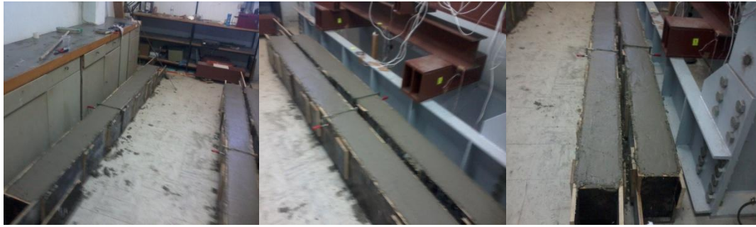
Σχήμα 4-4 Τα πειραματικά δοκίμια μετά τη σκυροδέτηση
