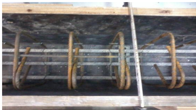
Σχήμα 4-3 Ο οπλισμός ράβδων C-FRP και ο διατμητικός οπλισμός
