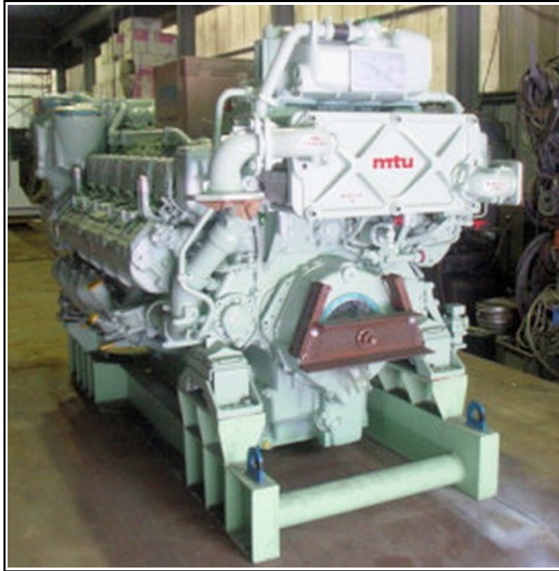
Σχήμα 1.7. Ναυτικός στροβιλο-υπερπληρωμένος κινητήρας Diesel MTU ισχύος 1470KW στις 2000 RPM.
