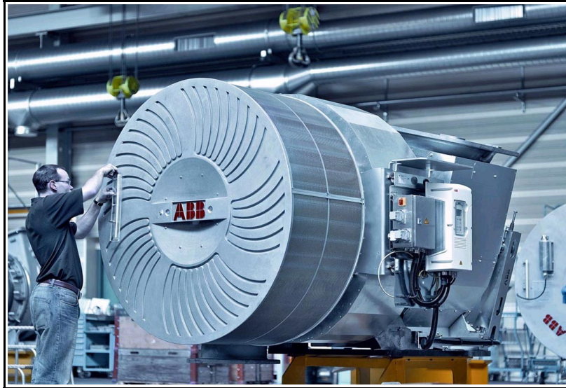
Σχήμα 2.8. Αποσιωπητήρας προσαρμοσμένος σε στροβιλο-υπερπληρωτή μεγάλου μεγέθους της εταιρίας ABB.
