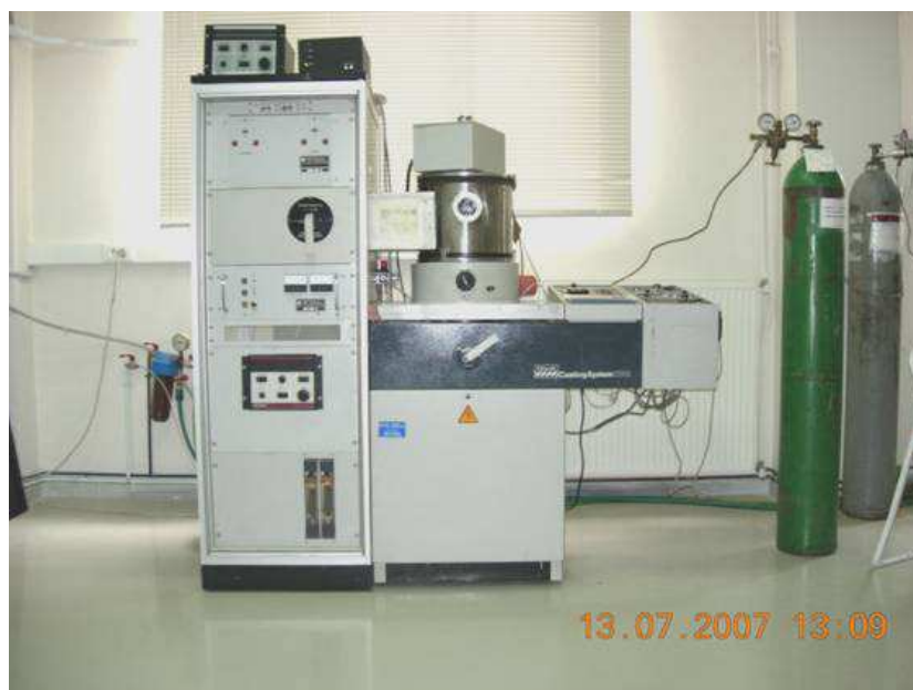
Σχήμα 3.1: Εικόνα της συσκευής μαγνητικά υποβοηθούμενης καθοδικής ιοντοβολής της “Edwards”, μοντέλο “E 306A Coating System”, που είναι εγκατεστημένη στο ΙΕΥ του ΕΚΕΦΕ «ΔΗΜΟΚΡΙΤΟΣ». Η συγκεκριμένη συσκευή χρησιμοποιήθηκε για την παρασκευή των λεπτών υμενίων της παρούσας διατριβής.
