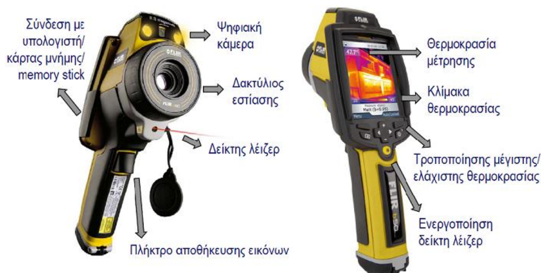
Εικόνα 5.2: Θερμοκάμερα FLIR b50
