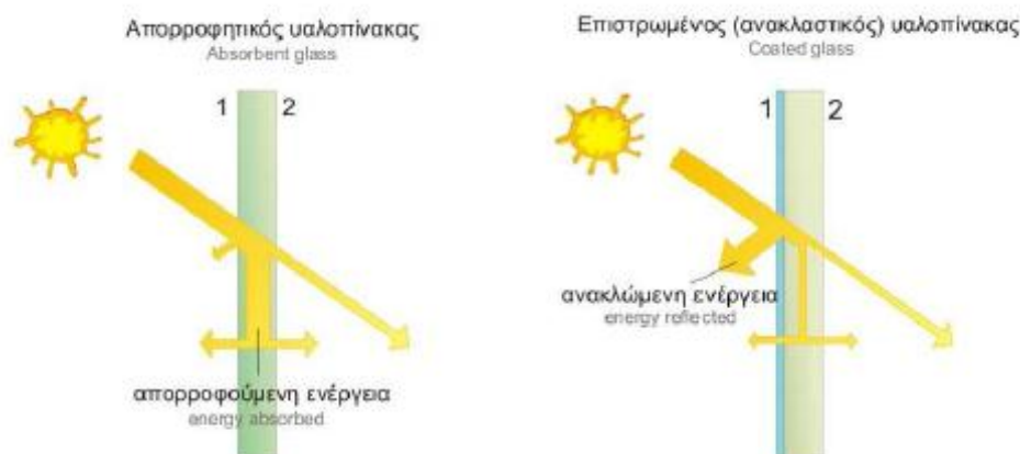
Εικόνα 6.3: Οπτική συμπεριφορά υαλοπίνακα χωρίς και με ανακλαστική επίστρωση
