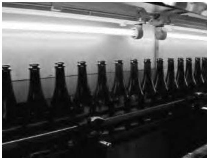
Εικόνα 2.4 Χρήση υπεριώδους ακτινοβολίας σε ταινία μεταφοράς [3]
