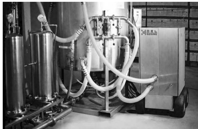
Εικόνα 4.6 Σύστημα CIP με όζον
