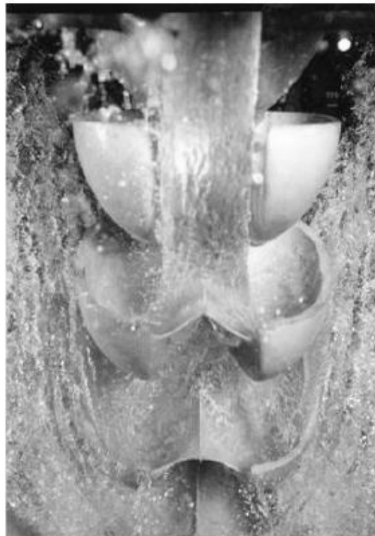
Σχήμα 1.33 Οπτικοποίηση της ροής στα σκαφίδια (Perrig, 2007)
