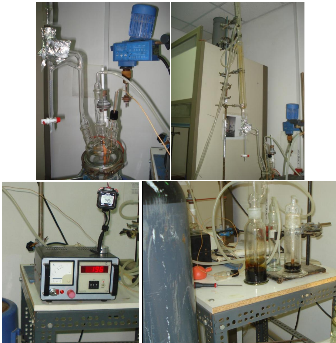
Σχήμα 5.2.1.3: Εξαρτήματα πειραματικής διάταξης πολυεστεροποίησης που χρησιμοποιήθηκαν για τη παρασκευή του πολυεστέρα MA6AA4: (α) καπάκι αντιδραστήρα με τις τέσσερις υποδοχές, (β) συμπυκνωτής υδρατμών και αιθυλενογλυκόλης, μαζί με προχοϊδα, (γ) ρυθμιστής θερμοκρασίας, (δ) πλυντρίδα πυρογαλλόλης
