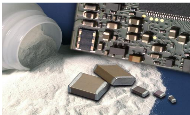
Σχήμα 3.5.5: Σκόνη καθαρού τιτανικού βαρίου και εφαρμογή του σε πυκνωτές BaTiO 3
