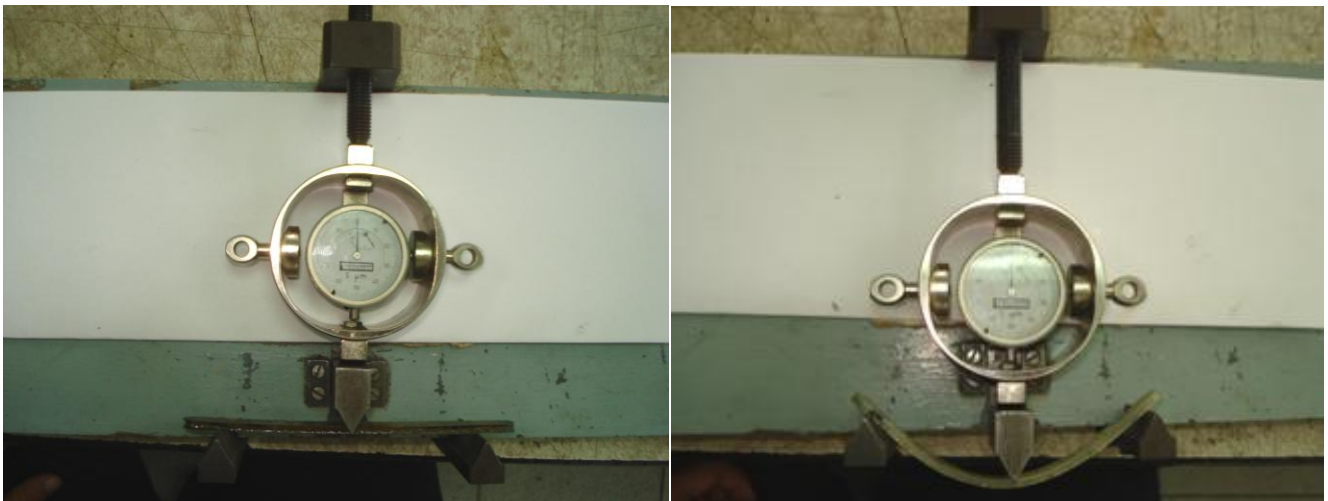
Σχήμα 8.2.3: Μηχανικές μετρήσεις αντοχής σε κάμψη: (α) σε δείγμα εμπορικού πολυεστέρα-τιτανικού βαρίου, (β) σε δείγμα MA6AA4 πολυεστέρα-τιτανικού βαρίου
