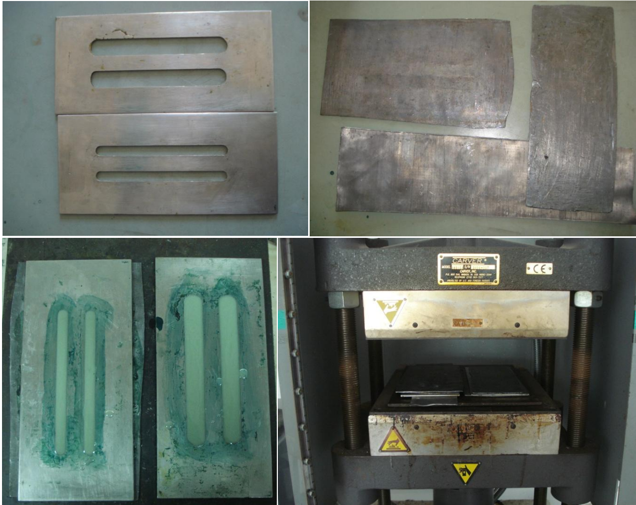
Σχήμα 6.3.1: Βήματα κατασκευής σύνθετων υλικών, μέσω των κλειστών καλουπιών: α) μήτρα από ανοξείδωτο χάλυβα, β) καπάκια μήτρας από μολύβδο, γ) στιγμιότυπο μίγματος στερεού/υγρού μέσα στην εσοχή της μήτρας, η οποία πριν έχει αλειφτεί με πολύ(βινυλική αλκοόλη), πριν πραγματοποιηθεί η σκλήρυνση, δ) στιγμιότυπο μήτρας τοποθετημένης στη θερμοπρέσσα, πριν την άσκηση πίεσης και θερμοκρασίας με σκοπό την σκλήρυνση του δοκιμίου
