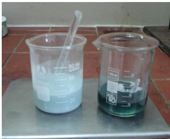
Σχήμα 6.3.3: Ποτήρι ζέσεως με καθαρό εμπορικό πολυεστέρα και MEKP (δεξιά) και μίγματος στερεού/υγρού αποτελούμενο από υγρό εμπορικό πολυεστέρα και στερεό με μορφή νανο-σωματιδίων τιτανικού βαρίου με περιεκτικότητα 20% w/w σε BaTiO 3 (αριστερά) έτοιμο προς τοποθέτηση στη μήτρα για μετέπειτα σκλήρυνση
