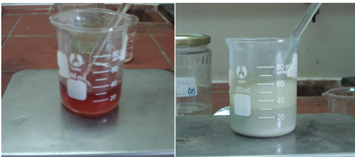
Σχήμα 6.3.4: Ποτήρι ζέσεως με πολυεστέρα MA6AA4, ναφθενικό κοβάλτιο και MEKP (αριστερά) και μίγματος στερεού/υγρού αποτελούμενο από υγρό πολυεστέρα MA6AA4-ναφθενικό κοβάλτιο-MEKP και στερεό με μορφή νανο-σωματιδίων τιτανικού βαρίου με περιεκτικότητα 20% w/w σε BaTiO 3 έτοιμο προς τοποθέτηση στη μήτρα για μετέπειτα σκλήρυνση (δεξιά)
