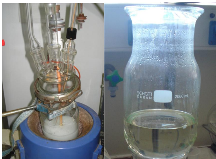
Σχήμα 6.1.1: Μορφή πολυεστέρα MA6AA4: στην έναρξη και στο τέλος της διαδικασίας του πολυμερισμού
