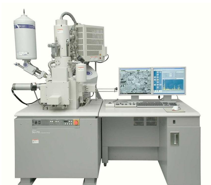
Σχήμα 7.1.1.1: α) Διάταξη ηλεκτρονικού μικροσκοπίου σάρωσης, SEM [126], β) Εργαστηριακή Διάταξη SEM
