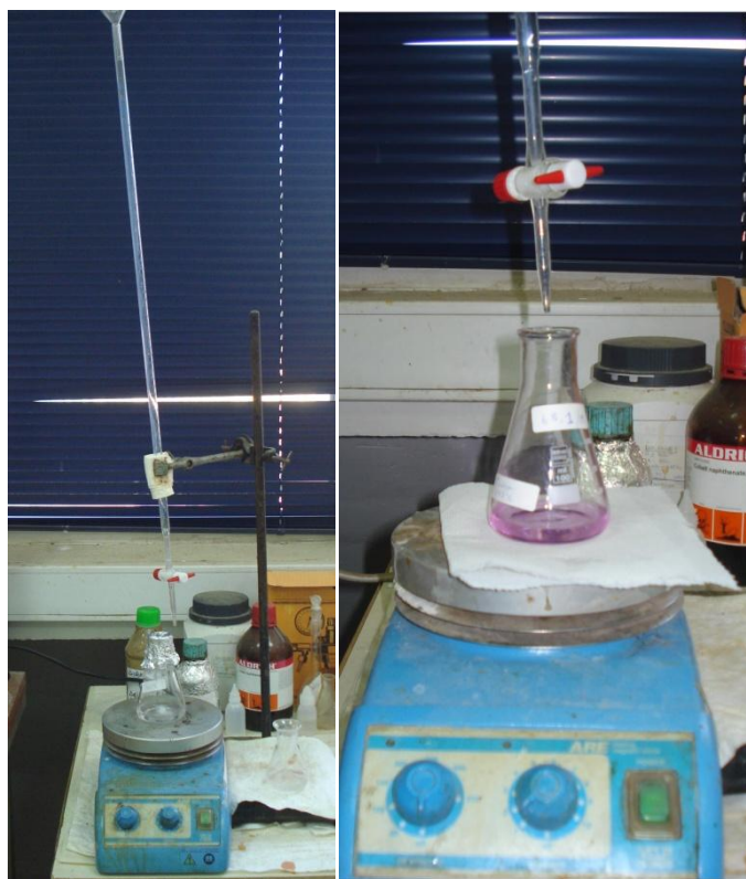
Σχήμα 5.3.1: Τιτλοδότηση με διάλυμα μεθανόλης-KOH, μέσω προχοΐδας
