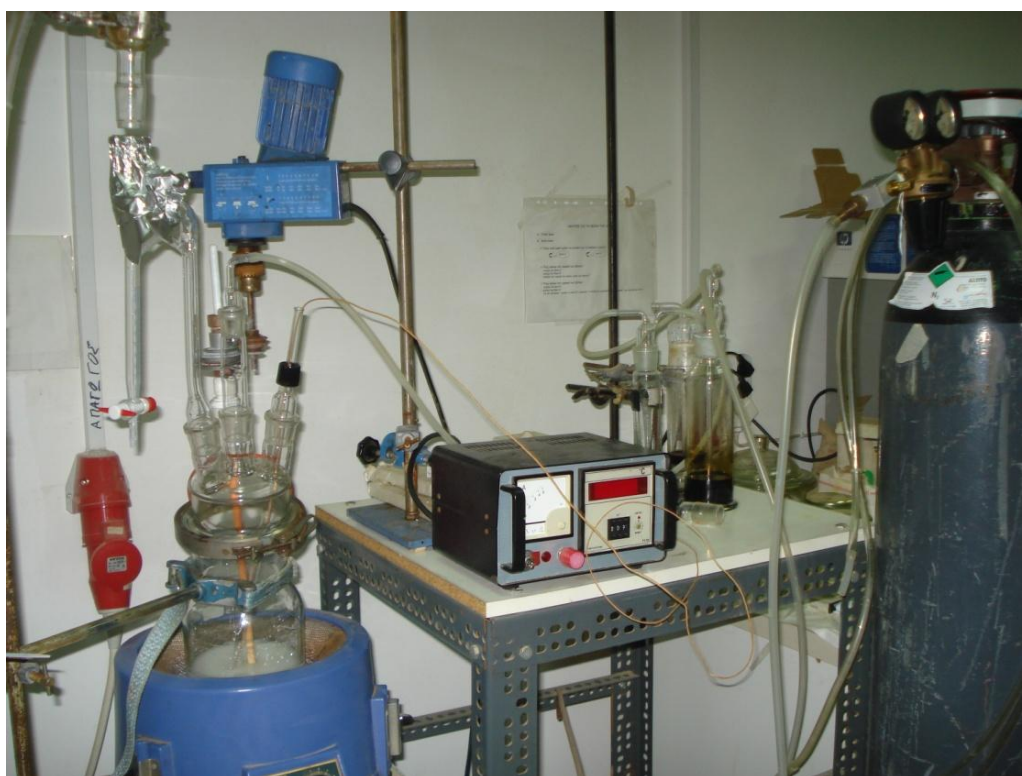
Σχήμα 5.2.1.2: Πειραματική διάταξη πολυεστεροποίησης, μέσω της μεθόδου της απόσταξης με ανακυκλοφορία που χρησιμοποιήθηκε για τη παρασκευή του πολυεστέρα MA6AA4
