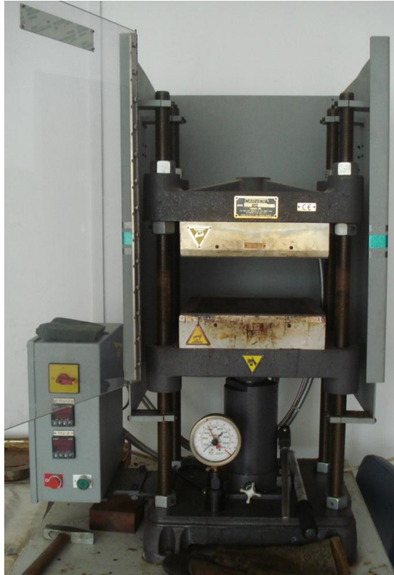
Σχήμα 6.3.2: Η θερμοπρέσα Carver, που χρησιμοποιήθηκε για την κατασκευή των δοκιμίων
