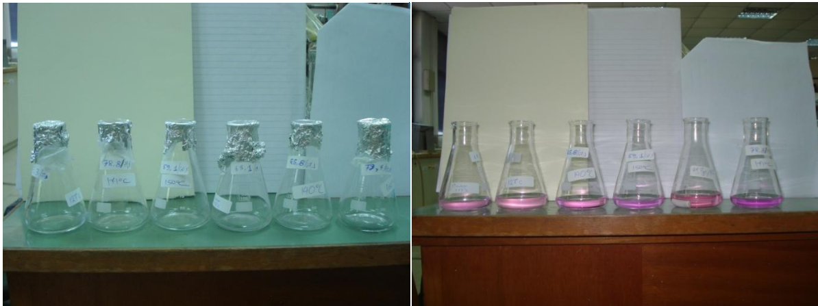
Σχήμα 5.3.2: Κωνικές φιάλες με τα έξι δείγματα των ισοθερμοκρασιακών μετρήσεων πριν και μετά τη τιτλοδότησή τους
