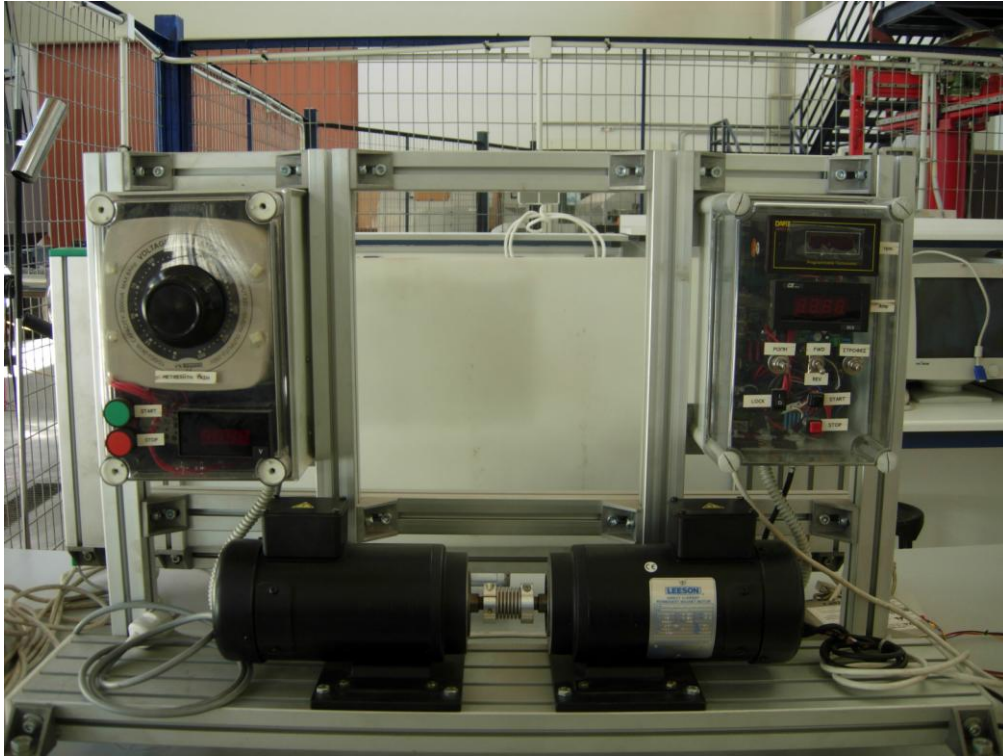
Σχήμα 3-1 Η ηλεκτρομηχανική διάταξη κινητήρων DC - DC
