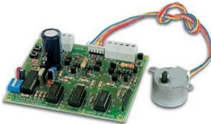
Σχήμα 2-8 Κάρτα οδήγησης βηματικού κινητήρα και κινητήρας, Η κάρτα μπορεί να χρησιμοποιηθεί για κινητήρες με μονοπολικά ή διπολικά τυλίγματα και παρέχει βήμα 0.9". Με χρήση επιπρόσθετης κάρτας, μπορεί να επικοινωνεί με υπολογιστή για έλεγχο του κινητήρα. Velleman,
