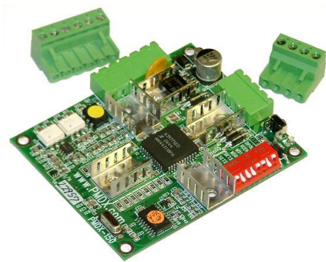
Σχήμα 2-9 Κάρτα Οδήγησης Βηματικού Κινητήρα με οδήγηση καταμητού για διπολική οδήγηση με μικροβηματισμό.
