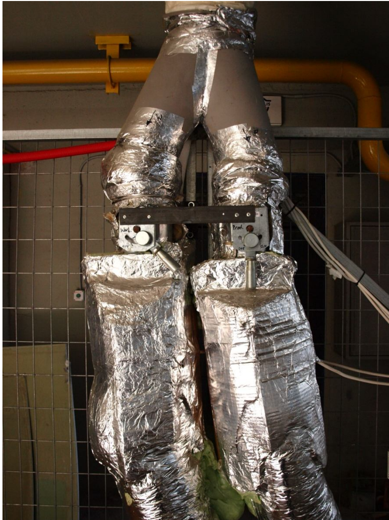
7. Σύστημα διακλάδωσης ρεύματος εργαζόμενο-ψυχόμενο
