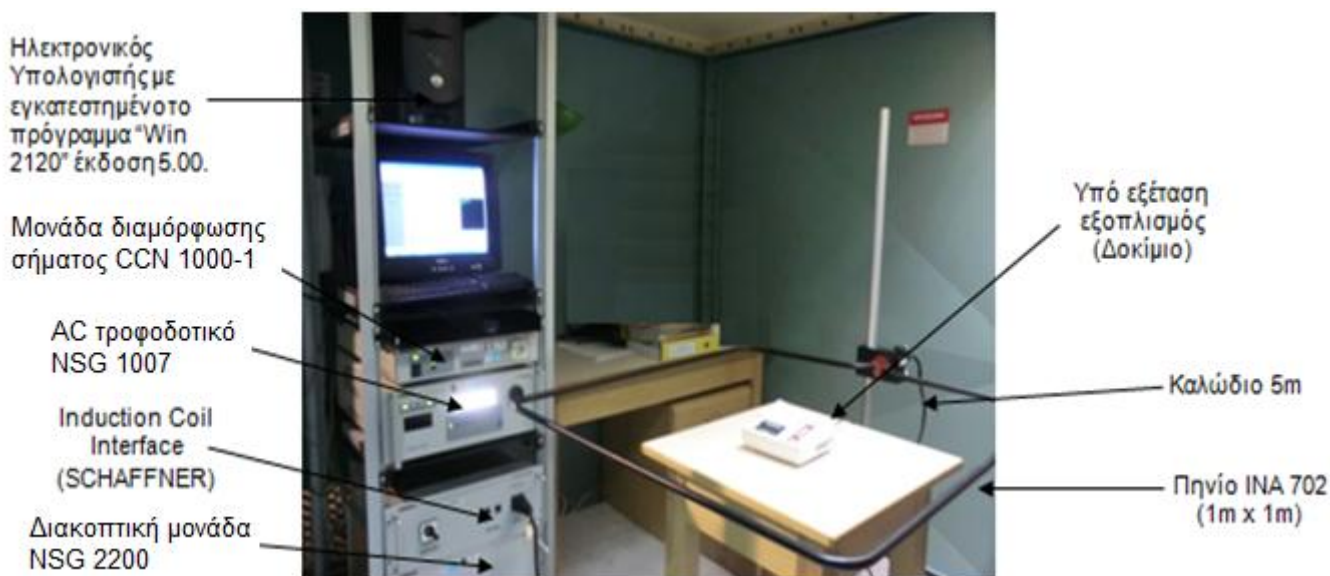
Σχήμα 4.37: Η πειραματική διάταξη της δοκιμής.
