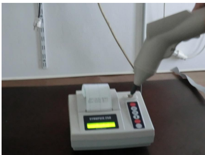
Σχήμα 4.3: Άμεση εφαρμογή εκκενώσεων μέσω επαφής στο δοκίμιο.
