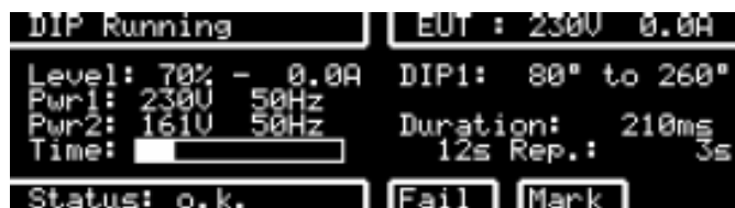
Σχήμα 4.34: Οθόνη γεννήτριας σε λειτουργία DIP AC (Interrupt) με DIPS μεγαλύτερα από μια περίοδο.
