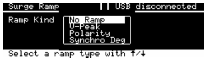
Σχήμα Γ.35: Ρύθμιση SURGE ramp.
