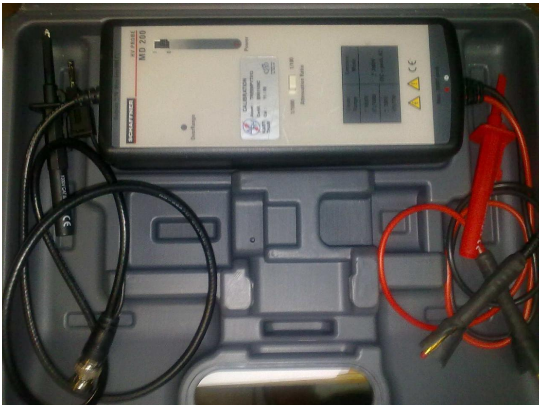
Σχήμα Ε.8: Διαφορικός καταμεριστής MD 200 της SCHAFFNER.
