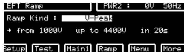
Σχήμα Γ.23: Επιλογή Ramp Kind V-peak.
