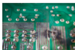
Catastrophic damage (burn-out)
