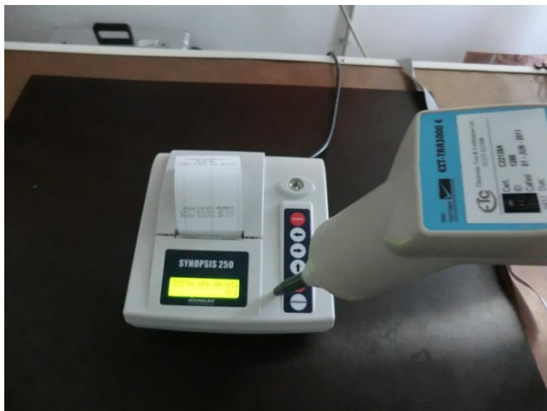
Σχήμα 4.2: Άμεση εφαρμογή εκκενώσεων μέσω αέρα στο περίβλημα του δοκιμίου.
