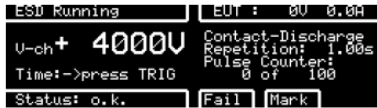
Σχήμα 4.9: Οθόνη γεννήτριας σε λειτουργία εκφόρτισης επαφής.
