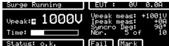
Σχήμα 4.25: Οθόνη γεννήτριας σε λειτουργία SURGE.
