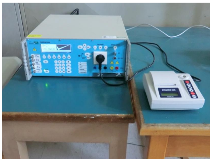
Σχήμα 4.36: Πειραματική διάταξη της δοκιμής (γεννήτρια και δοκίμιο).
