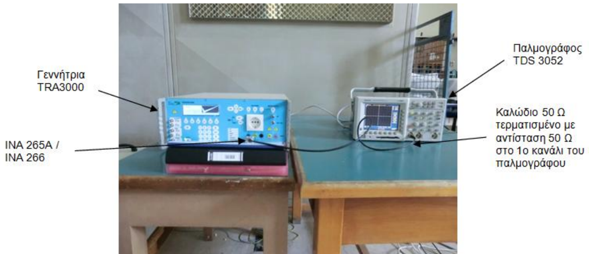
Σχήμα 4.20: Διάταξη σύνδεσης γεννήτριας, INA 265/INA 266 και παλμογράφου.
