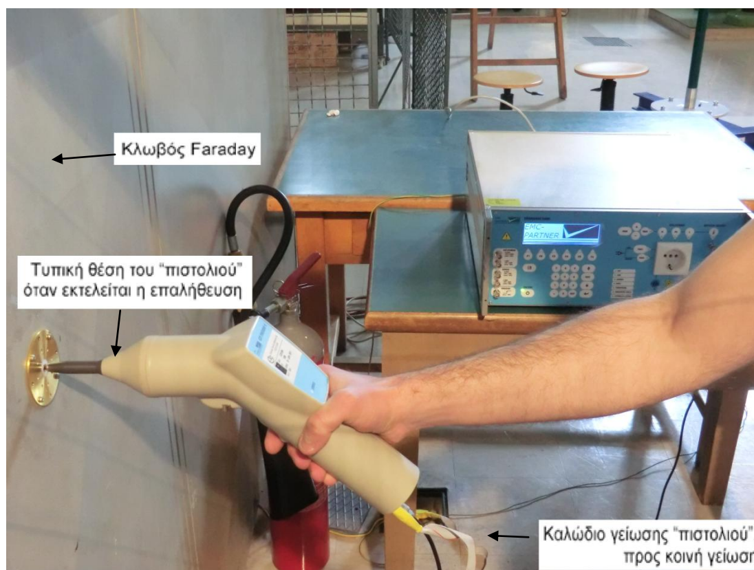
Σχήμα 4.6: Τα βασικά τμήματα της γεννήτριας TRA3000 και η μεταξύ τους συνδεσμολογία.
