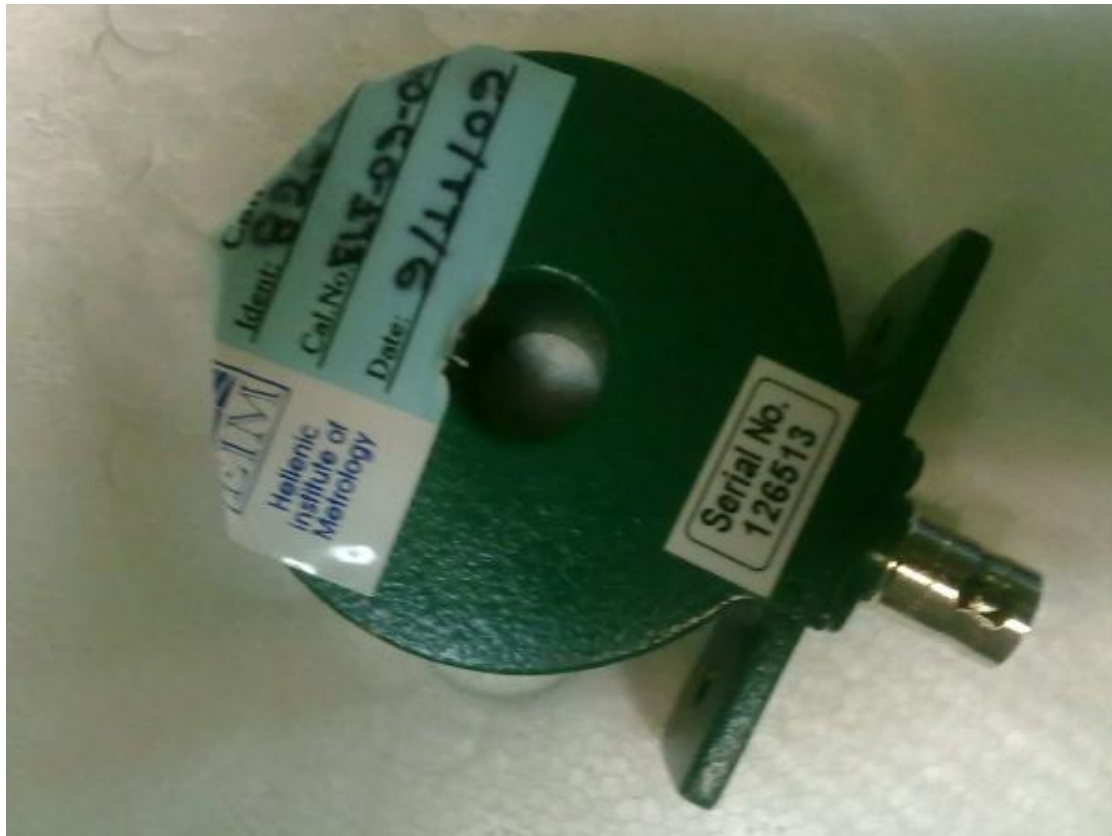
Σχήμα Ε.9: Current monitor (Αμπεροσιμπίδα) Pearson/8260.
