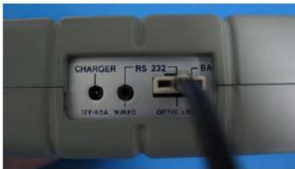
Σχήμα E.16: Σύνδεση πεδιομέτρου με την οπτική ίνα.
