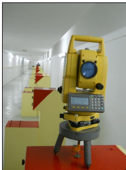
Εικόνα 16: Έλεγχος για κυκλικό σφάλμα σε σήραγγα.
