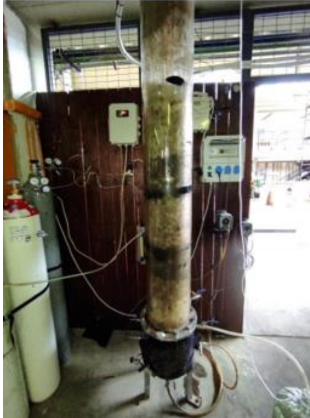
Εικόνα10: Κατανομή του υλικού πλήρωσης στον εσωτερικό όγκο του αντιδραστήρα
