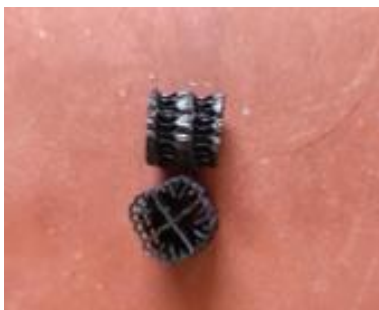
Εικόνα8: Πληρωτικό υλικό υψηλής ειδικής επιφάνειας ( 955 \text{ m}^2/\text{m}^3 ) HXF13KLL+
