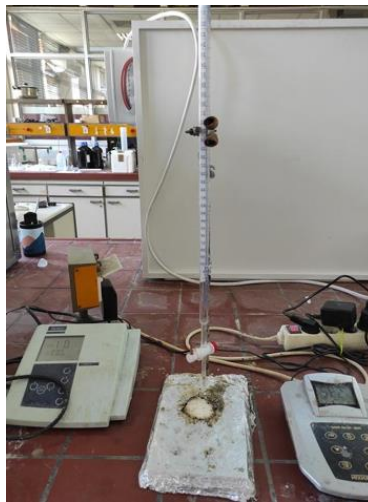
Εικόνα19: Εργαστηριακή διάταξη για τον προσδιορισμό της αλκαλικότητας.
