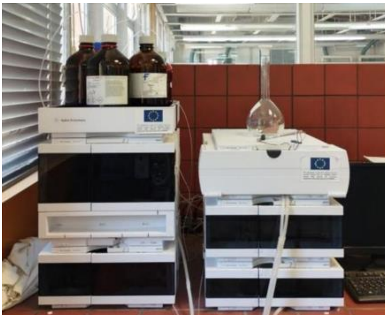
Εικόνα21: Υγρός Χρωματογράφος Υψηλής Απόδοσης Agilent 1260 InfinityII.
