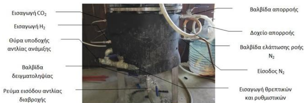
Εικόνα 11: Δοχείο συλλογής και αποθήκευσης του υγρού θρεπτικού διαλύματος
