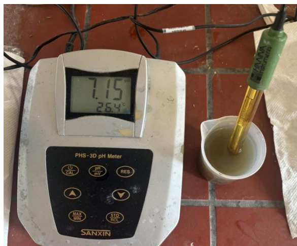
Εικόνα1: Ηλεκτρονικό πεχάμετρο SanxinPHS-3D-01 LabpHMeter και ηλεκτρόδιο HANNAinstrumentsHI1230
