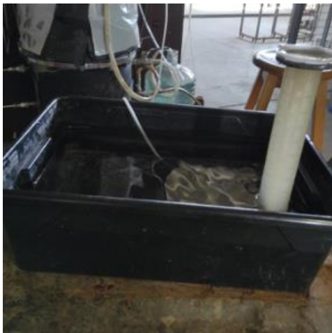
Εικόνα25: Πειραματική διάταξη προσδιορισμού ροής εξόδου βιοαερίου με ανάστροφο κύλινδρο.
