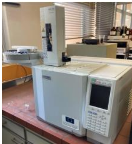
Εικόνα20: Αέριος χρωματογράφος SHIMADZU GC-2020 με ανιχνευτή φλόγας ιονισμού (FID) για τον προσδιορισμό VFAs.
