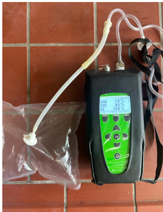
Εικόνα24: Φορητός Αναλυτής βιο-αερίου GFM 406
