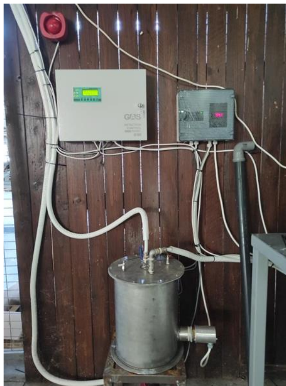
Εικόνα14: Ανοξείδωτο θερμαντικό δοχείο για παροχή θερμού νερού στο αντιδραστήρα
